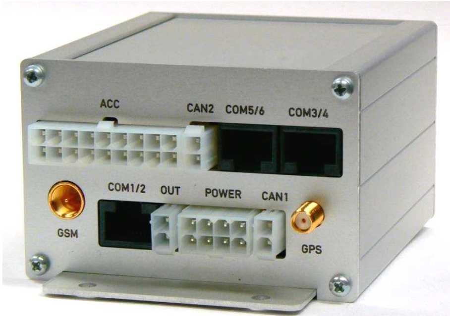
Obrázek č. 13 – Vozidlová GPS jednotka systému Fleetware typ CP Real Time Expanded (foto autor)
