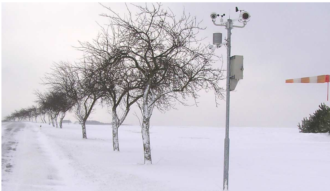
Obrázek č. 27 – Silniční meteostanice typ CROSSMET s kamerou u obce Lezník na sil.č. II/360 (foto autor)
