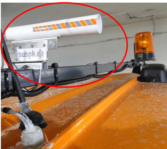
Obrázek č. 20, 21 – Montáž vozidlového teploměru Surface Patrol do vozidel typu T-815, detail umístění senzoru teploty vzduchu v clonícím krytu, umístění displeje v zorném poli řidiče (foto autor)
