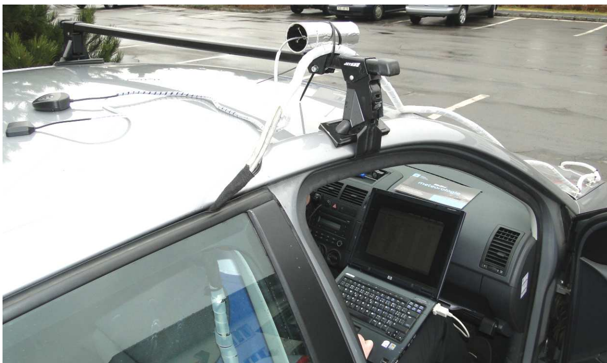
Obrázek č. 3 – Vybavení vozidla pro provádění termálního mapování spol. CROSS Zlín a.s., střešní senzor teploty vzduchu, GPS antény, počítač se SW pro měření (foto autor)
