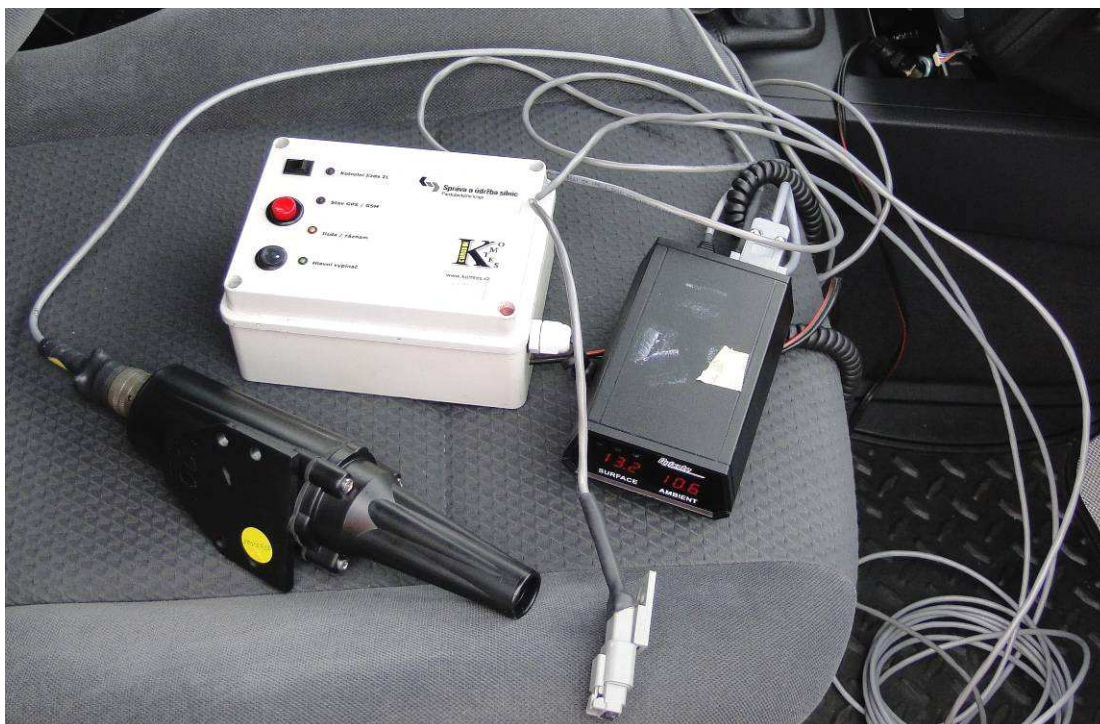
Obrázek č. 8 – vozidlový teploměr Surface Patrol 999J po napojení na GPS jednotku CP EASY před montáží snímačů na vozidlo(foto autor)
