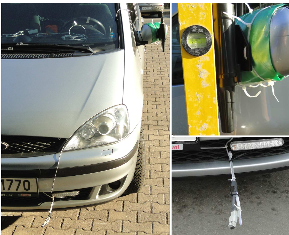
Obrázek č. 9 – vozidlový teploměr Surface Patrol 999J po napojení na GPS jednotku CP EASY a instalaci snímačů na vozidlo(foto autor)
