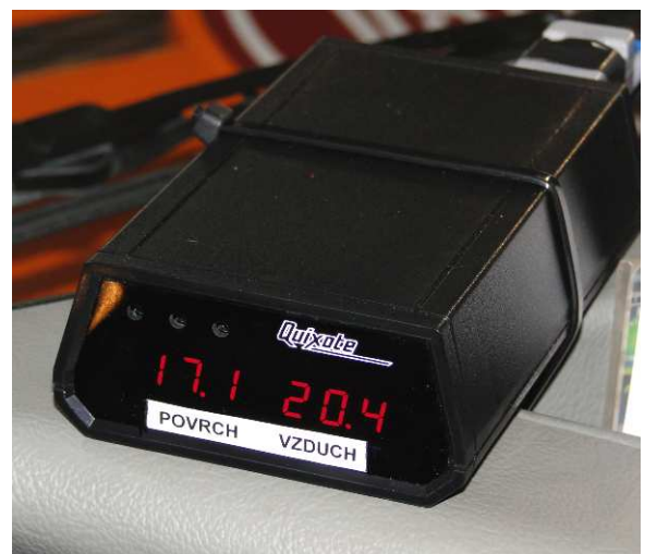
Obrázek č. 20, 21 – Montáž vozidlového teploměru Surface Patrol do vozidel typu T-815, detail umístění senzoru teploty vzduchu v clonícím krytu, umístění displeje v zorném poli řidiče (foto autor)
