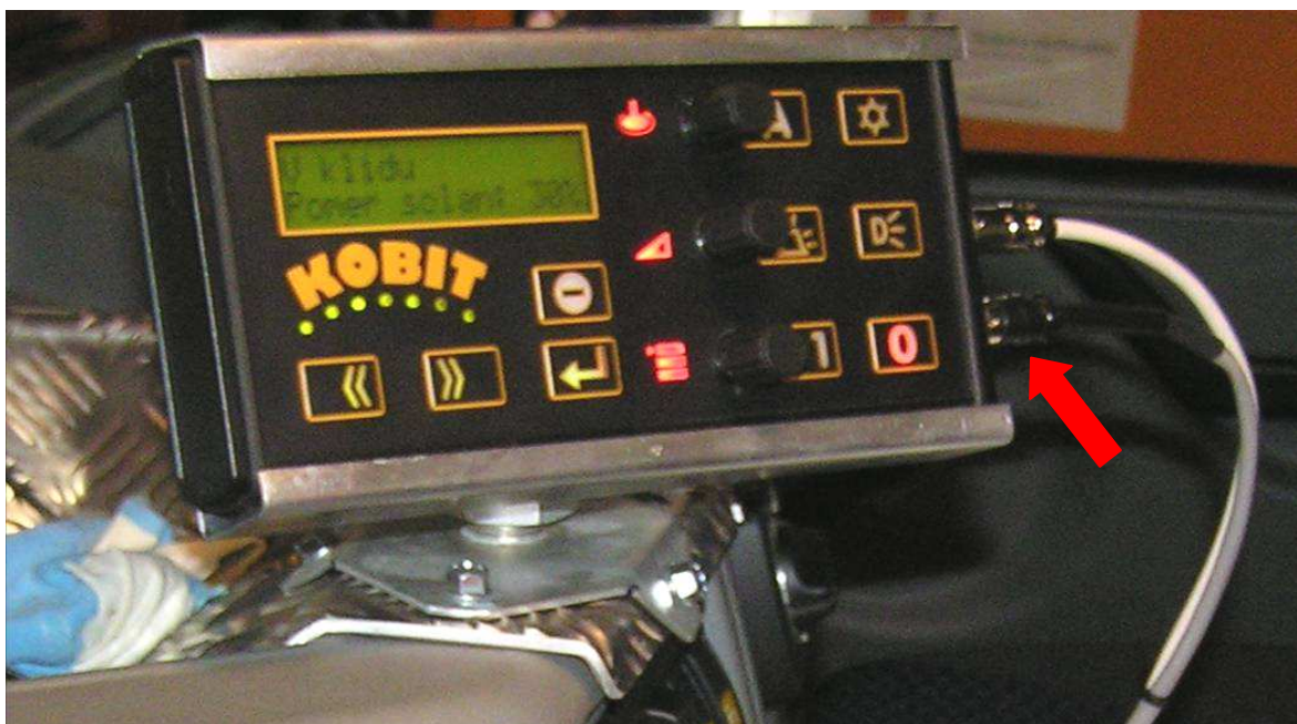
Obrázek č. 22 – Ovládací panel posypové nástavby SYKO (výrobce KOBIT Jičín) s doplněným aktivním výstupem technologických dat posypu (foto autor)
