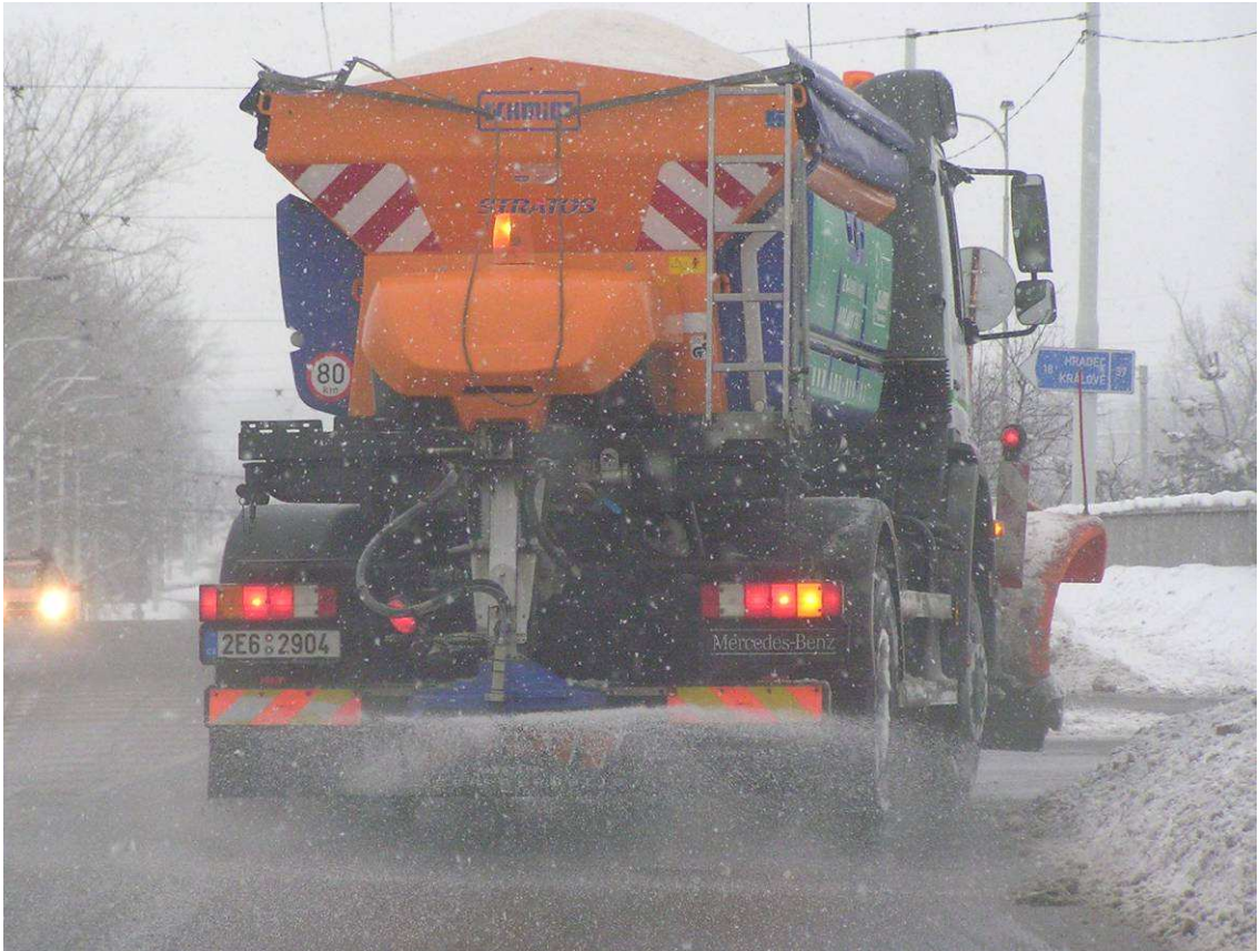
Foto příkladu nadměrného posypu na okruhu č. 45/1 sil. č.1/36 Pardubice-Doubravice (zdroj autor)
