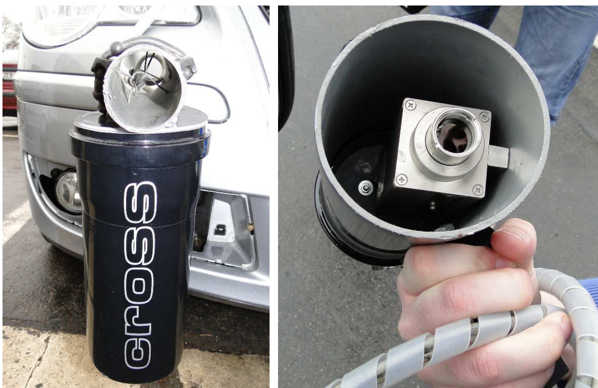
Obrázek č. 4 – Vybavení vozidla pro provádění termálního mapování spol. CROSS Zlín a.s., detail snímače teploty vzduchu nad vozovkou, trubice s infrateploměrem pro měření teploty povrchu (foto autor)
