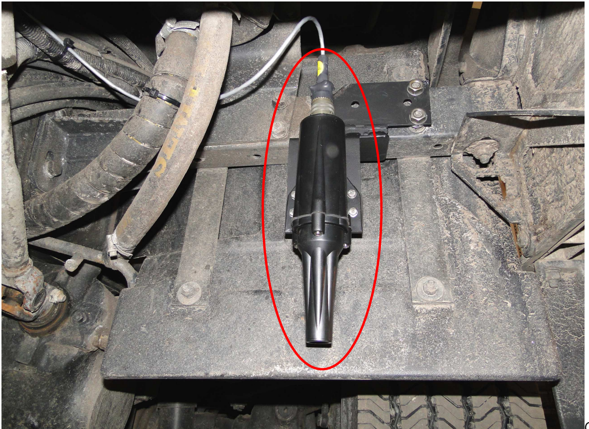
Obrázek č. 19 – Montáž vozidlového teploměru Surface Patrol do vozidel typů T-815, detail umístění infratrubice pro měření teploty povrchu vozovky vždy před levým předním kolem (foto autor)
