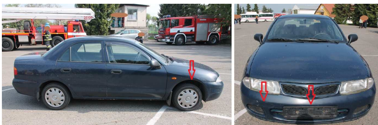
Obr. 4.1 – Vozidlo Mitsubishi, šipkami vyznačena místa měření rozměrů [foto J. Andres]
