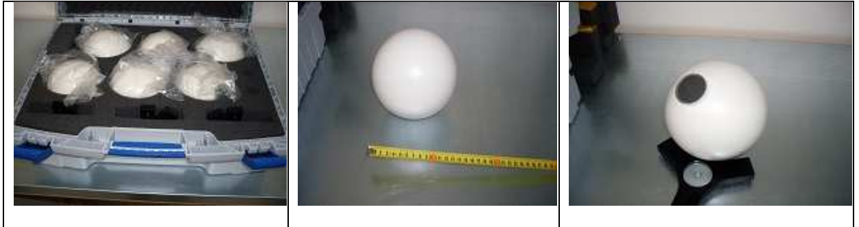
Obr. 3.4,5,6 – Balení vřícovacích koulí, porovnání s měřítkem, možnost uchycení koule magnetem nebo na stojánek [foto autor]
