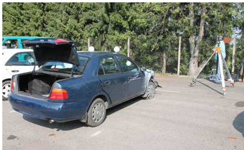
Obr. 3.8 – Skenování konkrétního vozidla [foto J. Andres]
