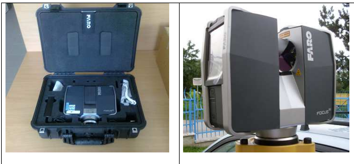
Obr. 3.1,2 – Skener v transportním kufríku včetně doplňků a celkový pohled na přístroj [foto autor]
