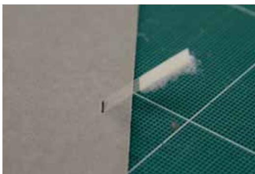
Obr. 109: Dle vějíře bylo naměřeno umístění proužků Melinexu držících přední a zadní krycí žebro 5 mm pod listem. Proužky široké 5 mm, provlečeny otvory vyřezanými v lepence, nalepeny zezadu oboustrannou lepicí páskou. Na konci nalepen suchý zip.
