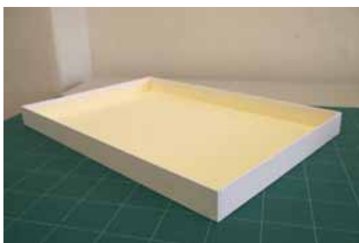
Obr. 113: Boky krabice byly zpevněny Filmoplastem T, vevnitř asi 1 cm pod horní hranu, zvenku několik centimetrů přes dno. Filmoplast lepen po částech, nejprve rohy krabice, potom celé boky.
