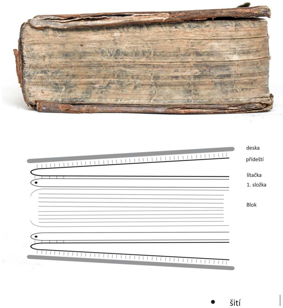
Obrázek 62 Předsádka. Silné šedé linie představují desky knihy. Zvýrazněné linie znázorňují listy předsádek. Kulatý bod označuje místo šití. Čárkované pole představuje místo lepeného spoje.
