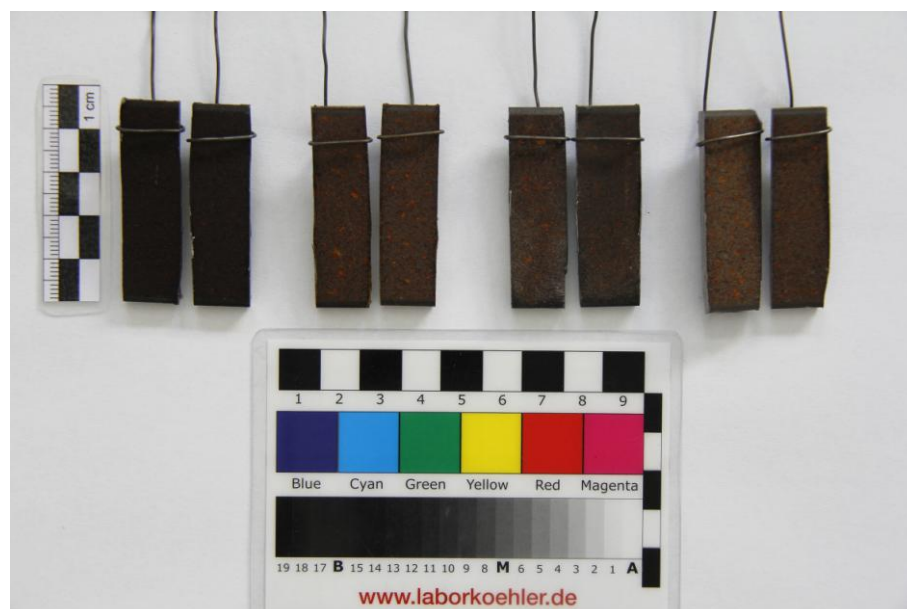
Obr. 66: Soubor vzorků tech. železa, stav po aplikaci inhibitorů, zleva: Indakor LAM (2ks), Ebol LMM (2ks), Ferrogard -903+ (2ks), neošetřené (2ks).
