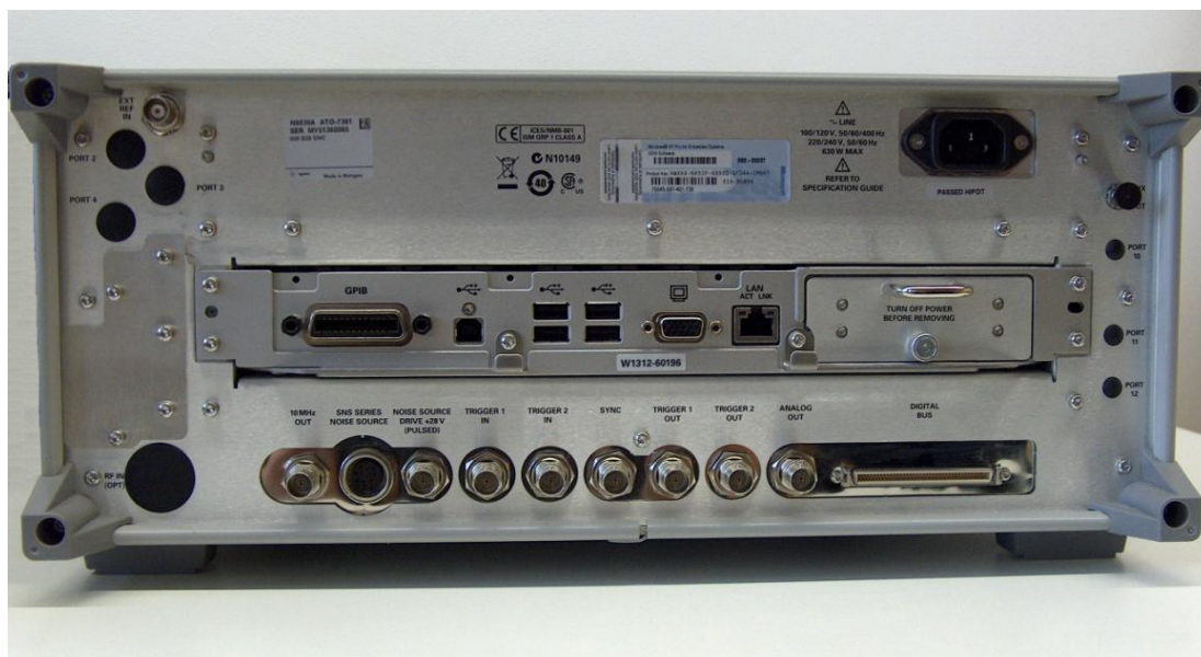
Obr. 28 – Signálový analyzátor – zadní panel
