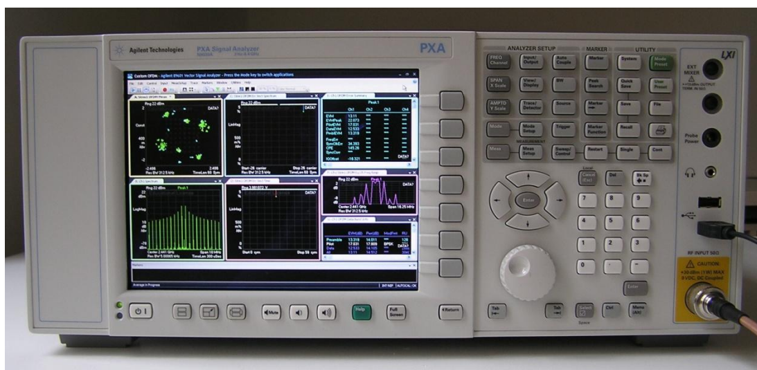
Obr. 27 – Signálový analyzátor – přední panel
