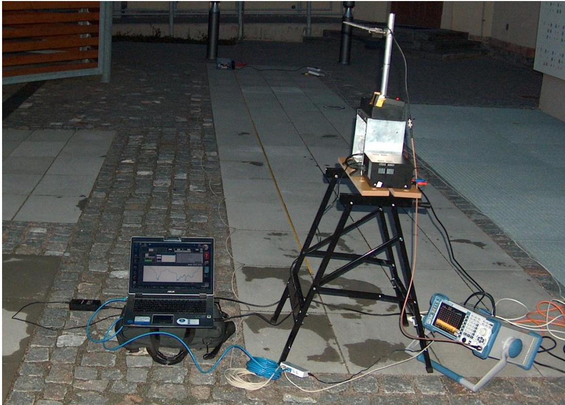
Obr. 41 – Přijímací část sestavy pro měření vyzařovacích charakteristik antény Yagi
