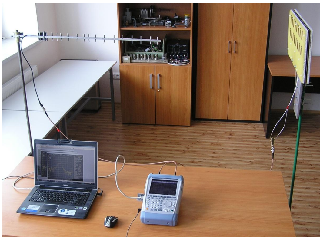
Obr. 48 – Měření frekvenční charakteristiky přenosu z Yagi antény do anténní řady pro RFID
