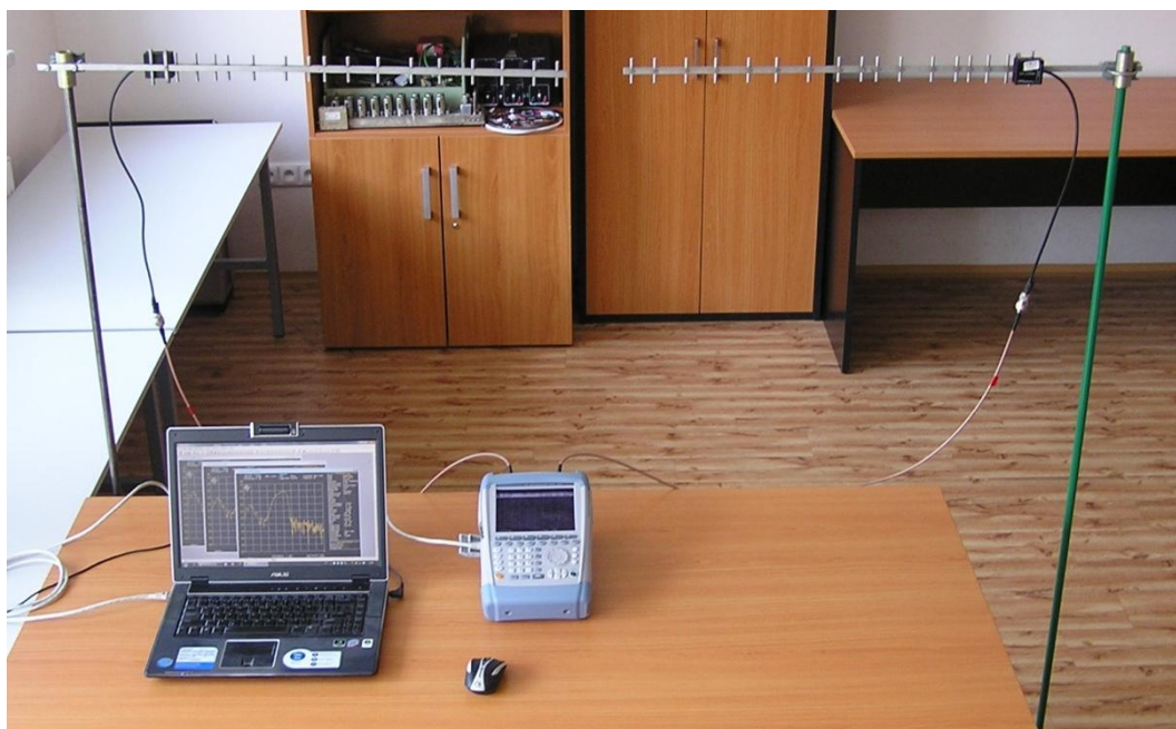
Obr. 52 – Měření frekvenční charakteristiky přenosu mezi anténami Yagi
