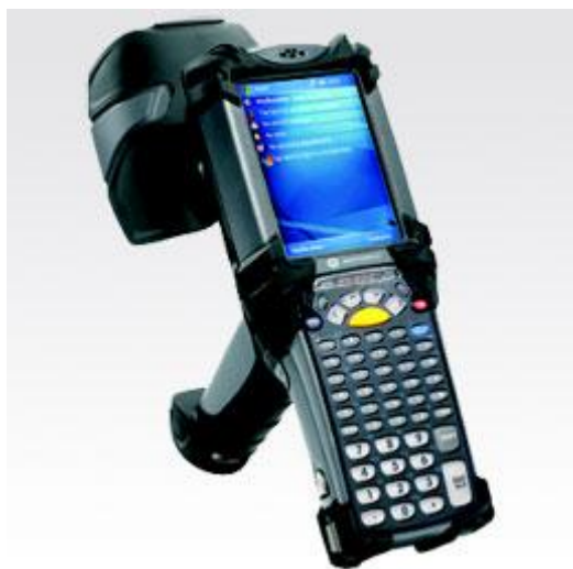
Obr. 3 – Mobilní čtečka RFID tagů [5]
