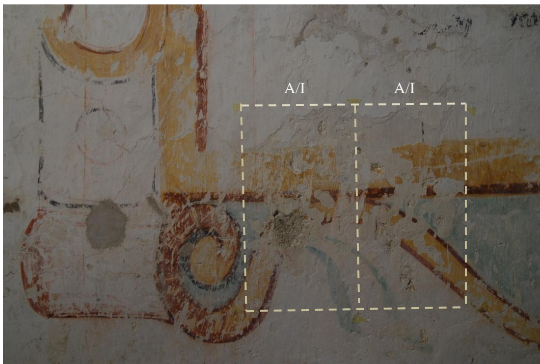
Obr. 22: Zkouška konsolidantu na barevné vrstvě. A/ I. CaLoSil 25, v poměru 1:3 s etanolem, A/II.CaLoSil 25, v poměru 1:1 s etanolem
