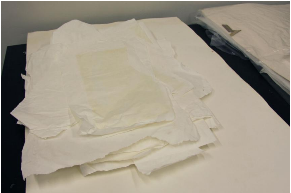
Obr. 90 Použité filtrační papíry pro vodno-etanolové obklady
