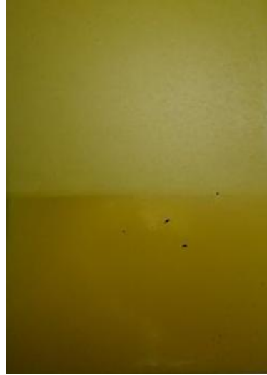
Obr. 6.22.: Nátěr ZnCrO_4 po 624 hodinové expozici QUV panelu
