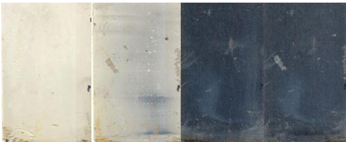
Obr. 6.4.: Nátěr Omycarb po expozici 168 hodin v kondenzační komoře, v pořadí 2 vrstvy nátěru, 1 vrstva nátěru po vytažení z kondenzační komory, a panely po stažení nátěru ve stejném pořadí
