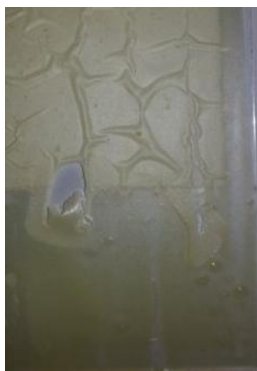
Obr. 6.18.: Nátěr Wolastonit po 624 hodinové expozici QUV panelu
