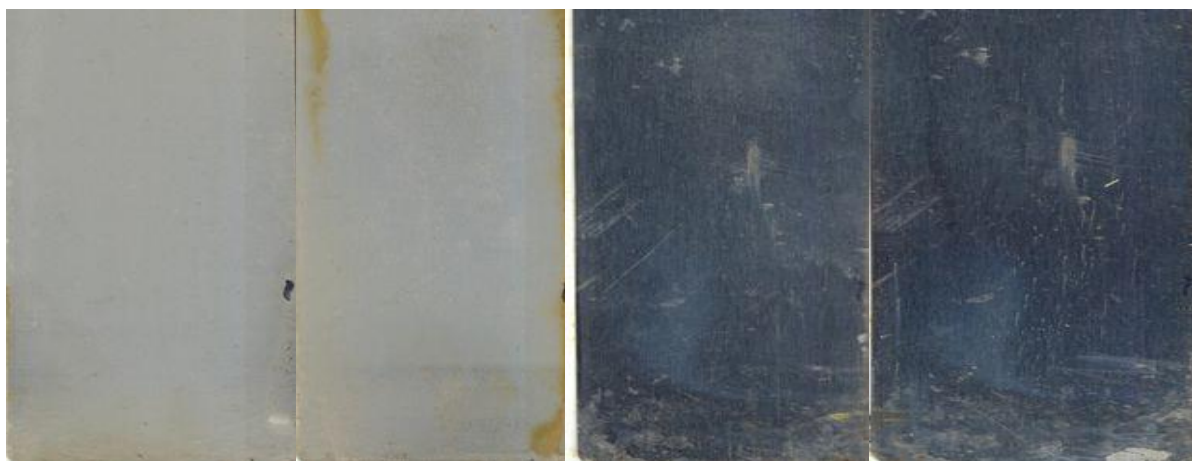
Obr. 6.13.: Nátěr Novinox po expozici 168 hodin v solné komoře, v pořadí 2 vrstvy nátěru, 1 vrstva nátěru po vytažení ze solné komory, a panely po stažení nátěru ve stejném pořadí
