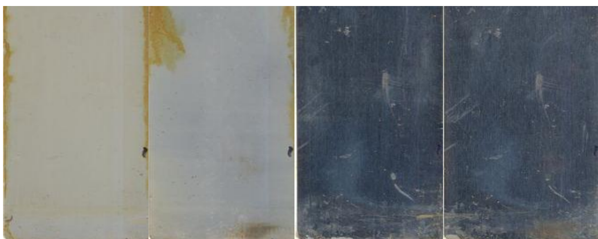
Obr. 6.14.: Nátěr Omyacarb po expozici 168 hodin v solné komoře, v pořadí 2 vrstvy nátěru, 1 vrstva nátěru po vytažení ze solné komory, a panely po stažení nátěru ve stejném pořadí
