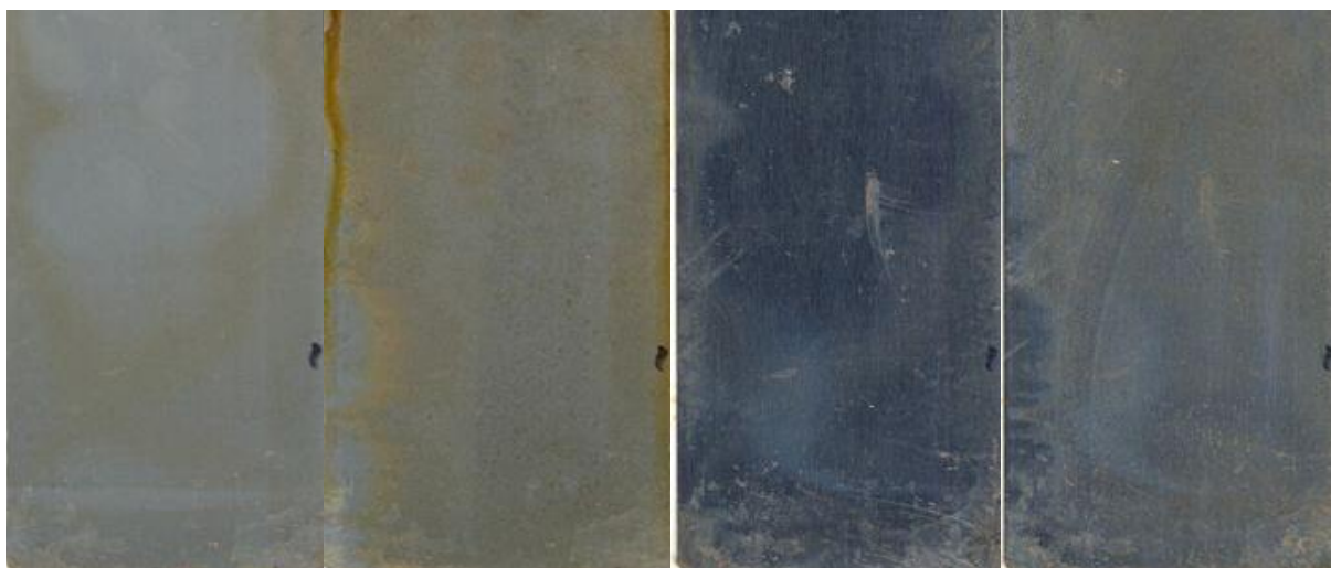
Obr. 6.12.: Nátěr Micromica po expozici 168 hodin v solné komoře, v pořadí 2 vrstvy nátěru, 1 vrstva nátěru po vytažení ze solné komory, a panely po stažení nátěru ve stejném pořadí
