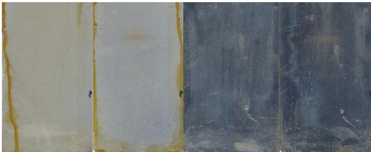
Obr. 6.16.: Nátěr Butrol po expozici 168 hodin v solné komoře, v pořadí 2 vrstvy nátěru, 1 vrstva nátěru po vytažení ze solné komory, a panely po stažení nátěru ve stejném pořadí
