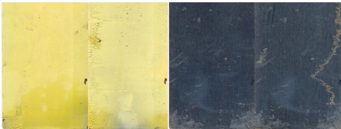
Obr. 6.1.: Nátěr ZnCrO_4 po expozici 168 hodin v kondenzační komoře, v pořadí 2 vrstvy nátěru, 1 vrstva nátěru po vytažení z kondenzační komory, a panely po stažení nátěru ve stejném pořadí
