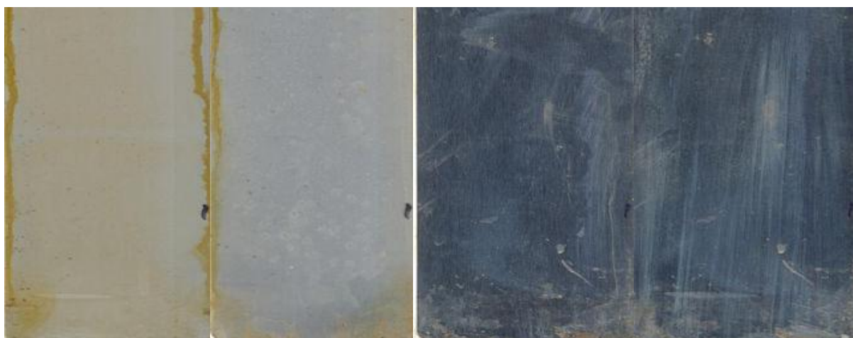
Obr. 6.15.: Nátěr SRPP po expozici 168 hodin v solné komoře, v pořadí 2 vrstvy nátěru, 1 vrstva nátěru po vytažení ze solné komory, a panely po stažení nátěru ve stejném pořadí
