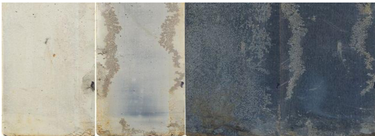
Obr. 6.7.: Nátěr SRPP po expozici 168 hodin v kondenzační komoře, v pořadí 2 vrstvy nátěru, 1 vrstva nátěru po vytažení z kondenzační komory, a panely po stažení nátěru ve stejném pořadí
