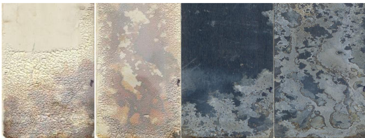
Obr. 6.3.: Nátěr Butrol po expozici 168 hodin v kondenzační komoře, v pořadí 2 vrstvy nátěru, 1 vrstva nátěru po vytažení z kondenzační komory, a panely po stažení nátěru ve stejném pořadí
