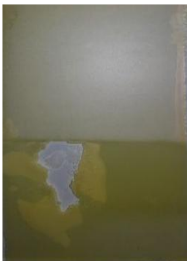
Obr. 6.19.: Nátěr Butrol po 624 hodinové expozici QUV panelu
