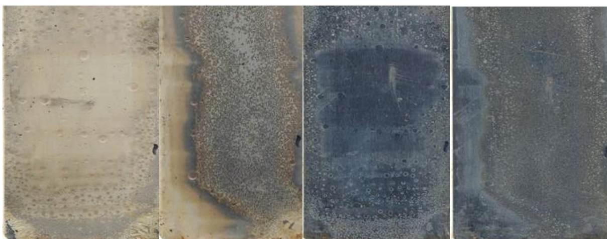
Obr. 6.8.: Nátěr Micromica po expozici 168 hodin v kondenzační komoře, v pořadí 2 vrstvy nátěru, 1 vrstva nátěru po vytažení z kondenzační komory, a panely po stažení nátěru ve stejném pořadí
