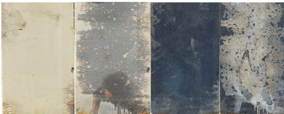
Obr. 6.6.: Nátěr Wolastonit po expozici 168 hodin v kondenzační komoře, v pořadí 2 vrstvy nátěru, 1 vrstva nátěru po vytažení z kondenzační komory, a panely po stažení nátěru ve stejném pořadí
