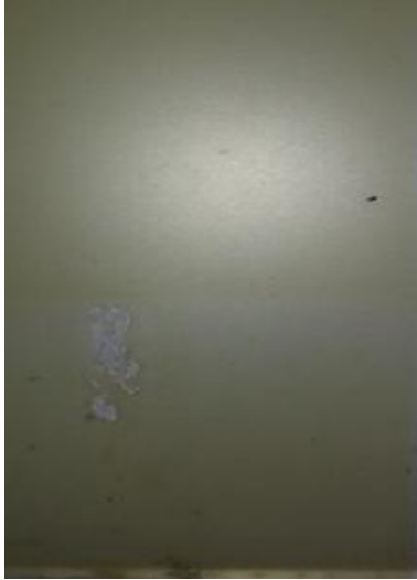
Obr. 6.21.: Nátěr Micromica po 624 hodinové expozici QUV panelu
