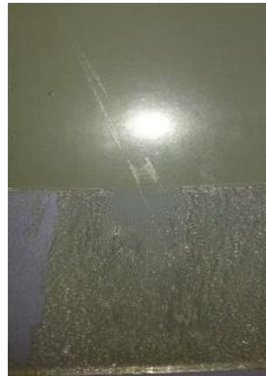
Obr. 6.24.: Nátěr Unithane po 624 hodinové expozici QUV panelu
