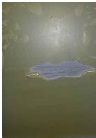
Obr. 6.20.: Nátěr Omyacarb po 624 hodinové expozici QUV panelu
