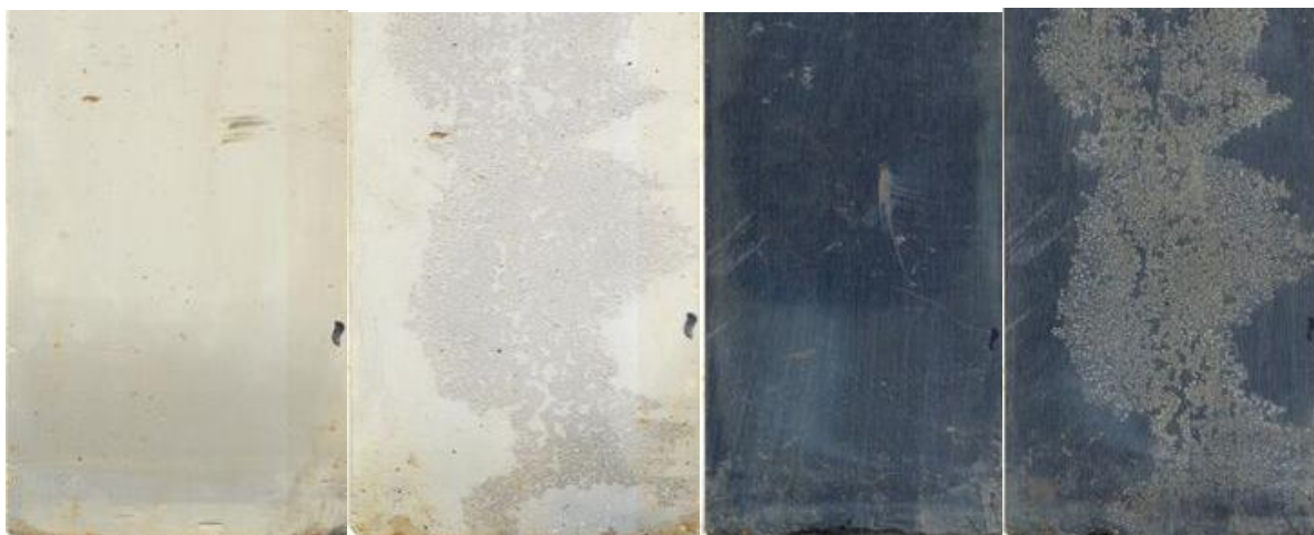
Obr. 6.5.: Nátěr Novinox po expozici 168 hodin v kondenzační komoře, v pořadí 2 vrstvy nátěru, 1 vrstva nátěru po vytažení z kondenzační komory, a panely po stažení nátěru ve stejném pořadí
