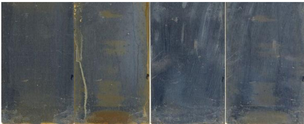
Obr. 6.10.: Nátěr Unithane po expozici 168 hodin v solné komoře, v pořadí 2 vrstvy nátěru, 1 vrstva nátěru po vytažení ze solné komory, a panely po stažení nátěru ve stejném pořadí
