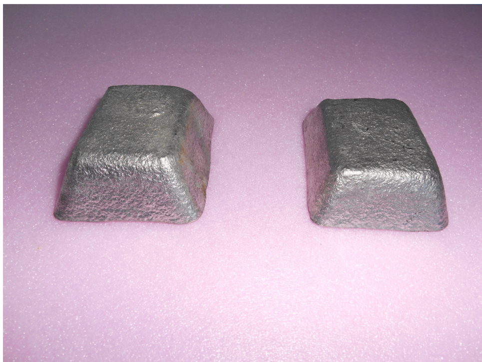
Obrázek 12 – Woodův kov v pevném stavu, před tavením
