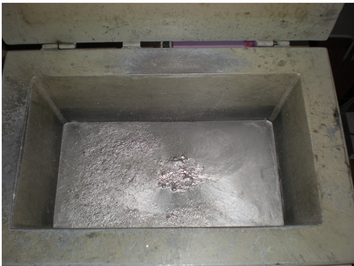
Obrázek 13 – Woodův kov při tavení (v kapalném stavu)
