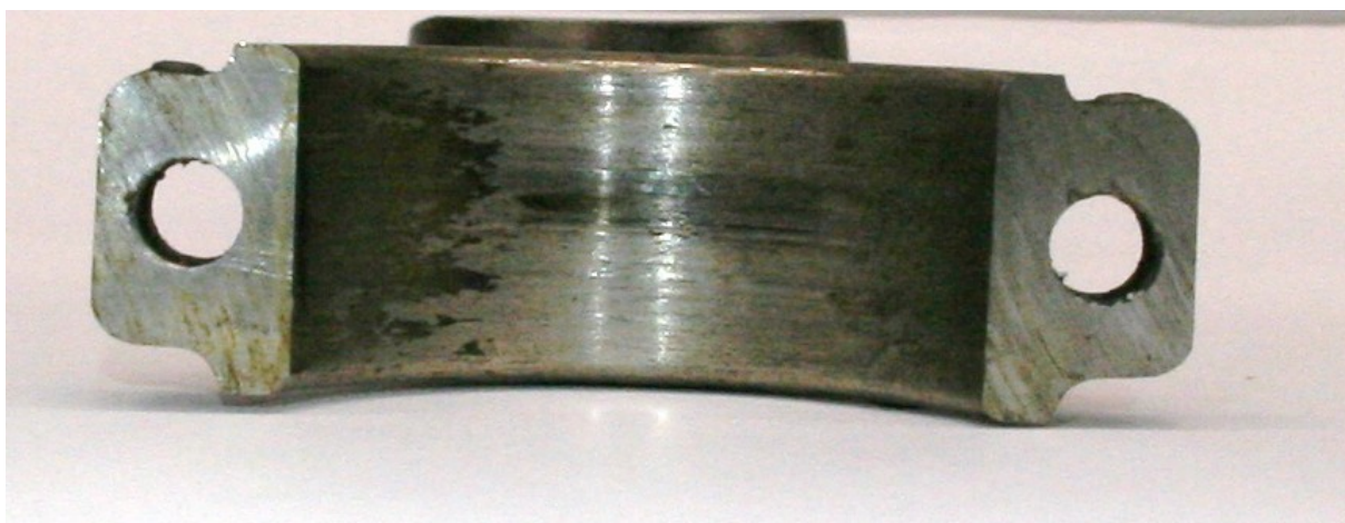
Obrázek 24: Fotografie vnitřní části paty ojnice se známkami tepelného zatížení.
