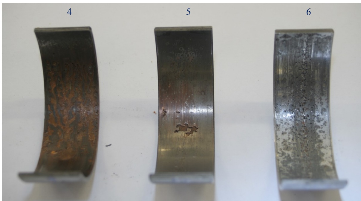
Obrázek 9: Poškozené ojniční pánve, vzorky 4,5,6.
