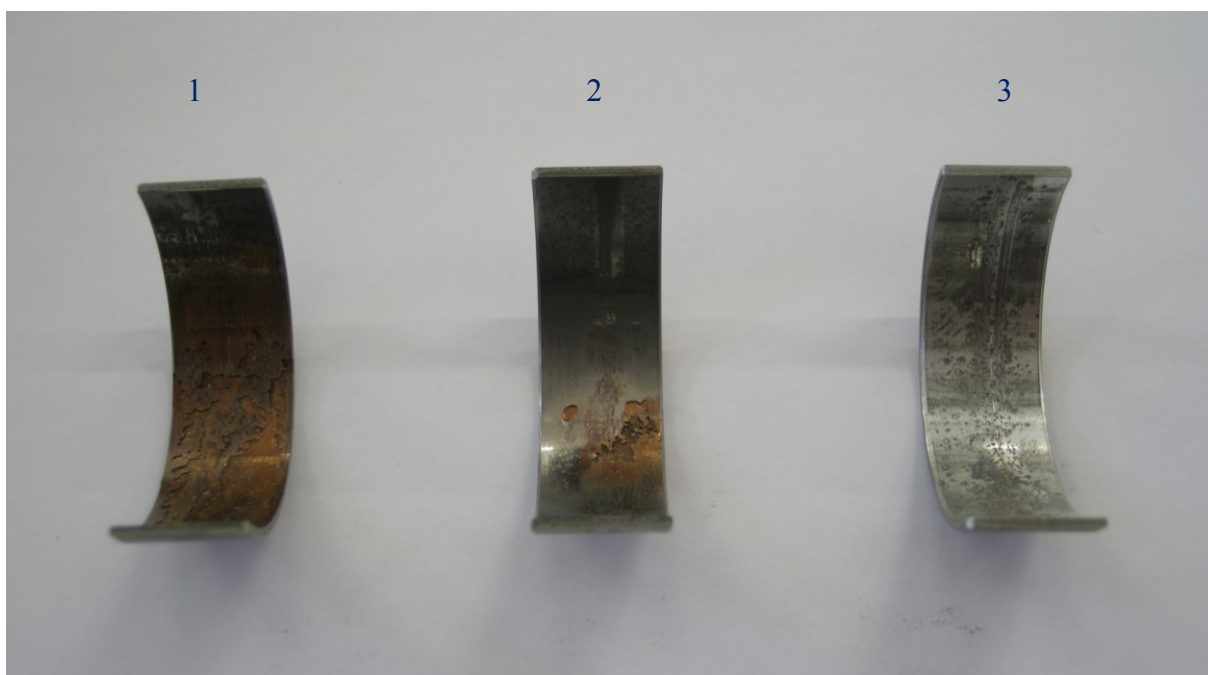
Obrázek 8: Poškozené ojnicní pánve, vzorky 1,2,3.
