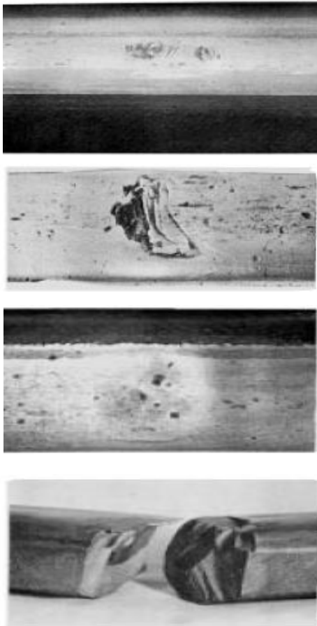
Obr. 1.9 Místa vybroušená jednorázovým Prokluzem
