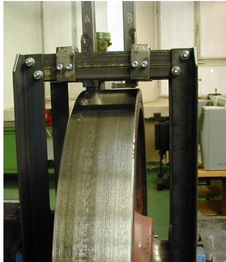
Obr. 3.2 Systém upnutí a souběžného zatížení testovaných vzorků maziv
