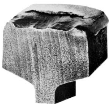
Obr. 1.8 Odlupování materiálu na hraně pojížděné plochy
