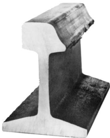
Obr. 1.5 Boční opotřebení hlavy kolejnice
