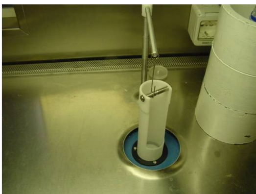
Obrázek 6: Studnová ionizační komora
