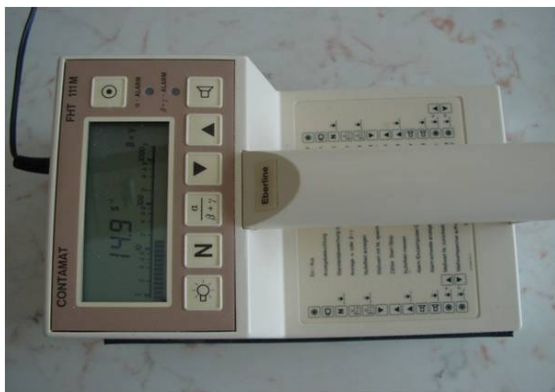
Obrázek 8: Proporcionální xenonový detektor
