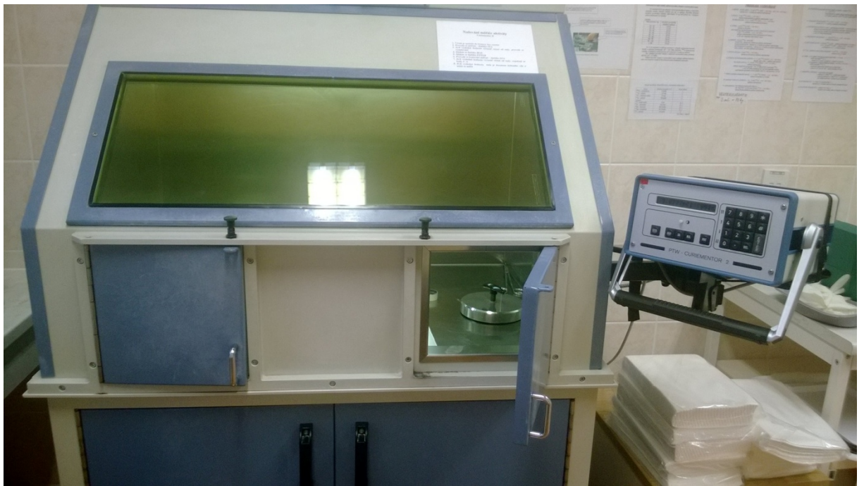
Obrázek 30: Digestoř pro přípravu radiofarmak (laboratoř ONM FNHK)
