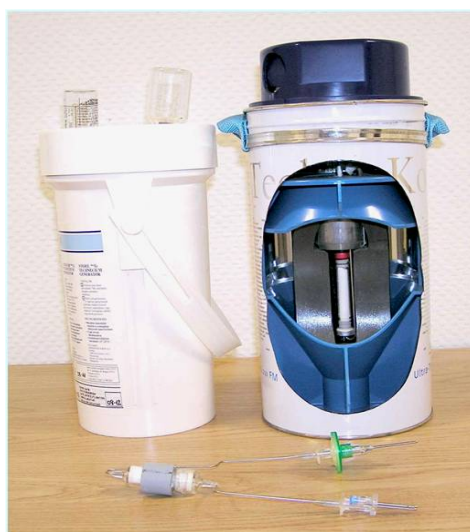
Obrázek 20: Eluční generátor ^{99}\text{Mo} - ^{99m}\text{Tc}
