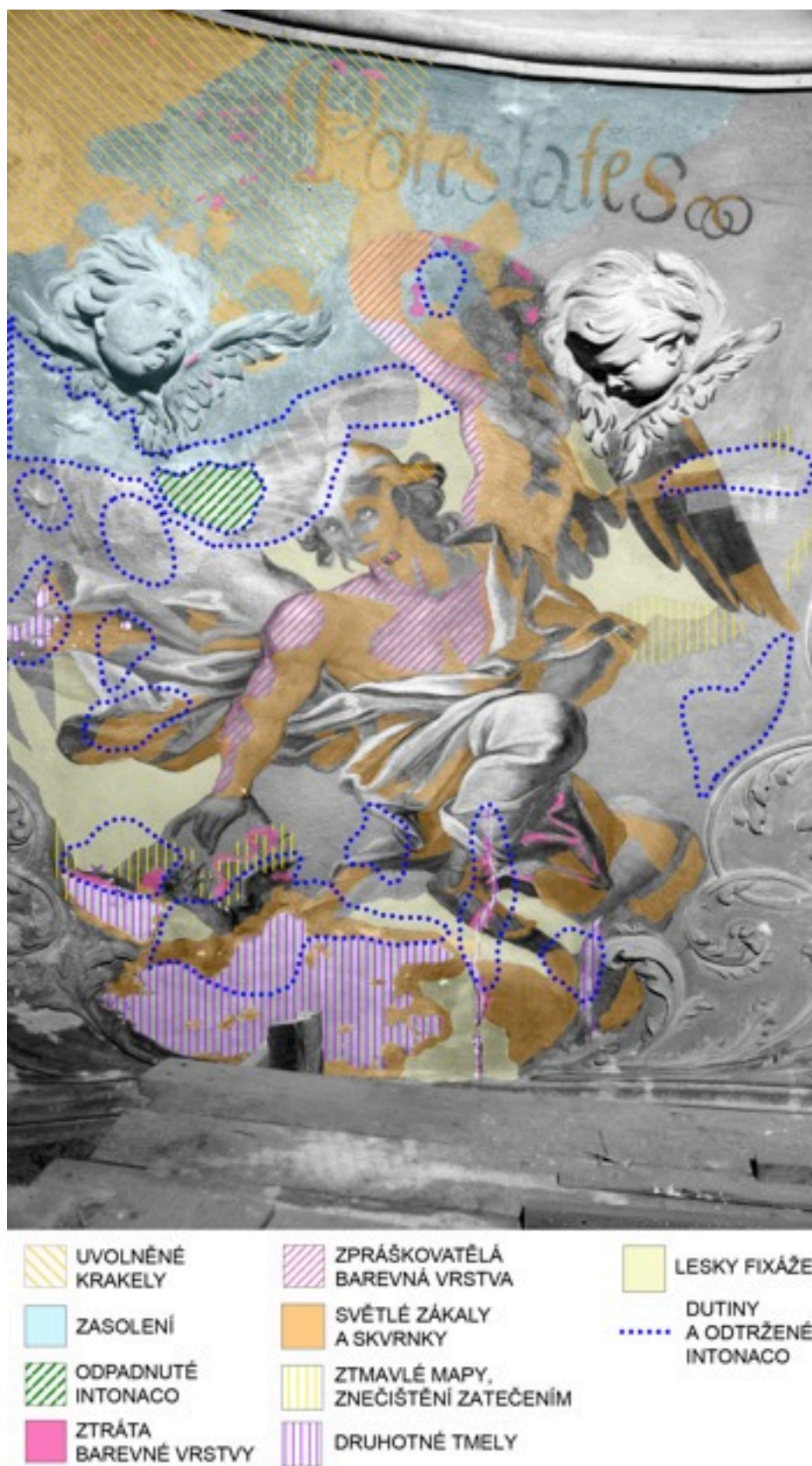
Obr. č. 59 Grafické zakreslení poškození na úseku nástěnné malby s motivem Potestates
