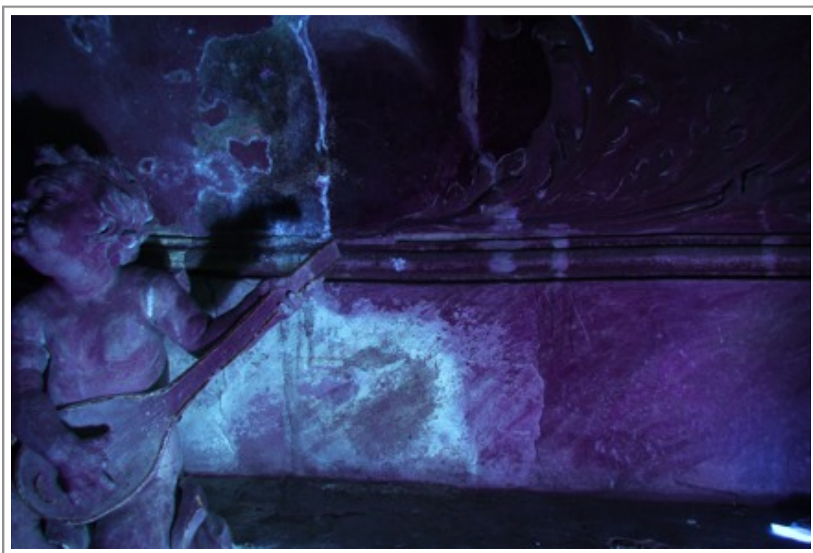
Obr. č. 31 Pás s oblaky a oblak ve výjevu, průzkum u UV záření: výrazná modrozelená fluorescence partie, která byla patrně vystavena zatékání
