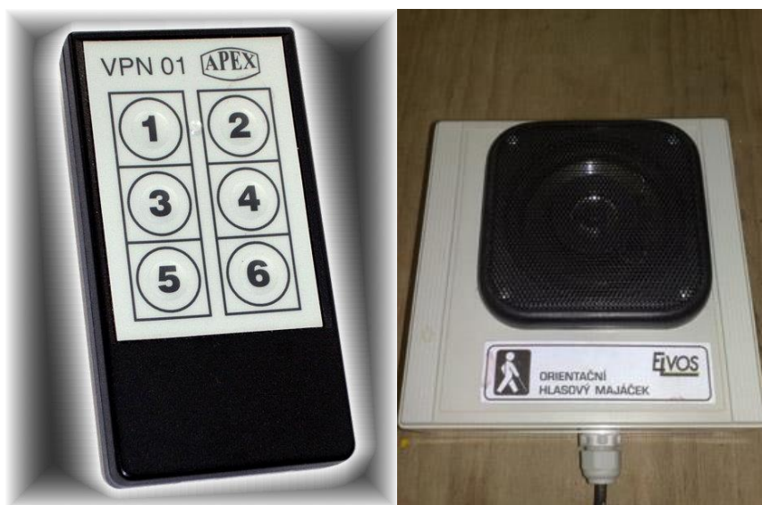
Obr. 2 Dálkový ovladač - slepecká vysílačka typu VPN
