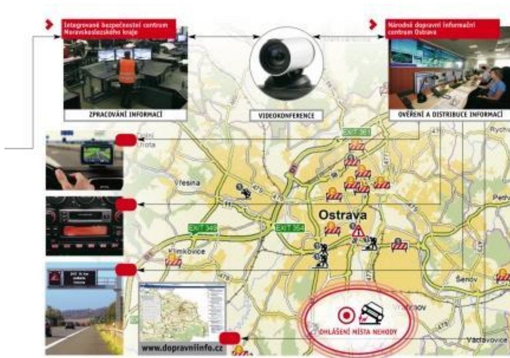
Obr. 26 Zjednodušené schéma práce NDIC
