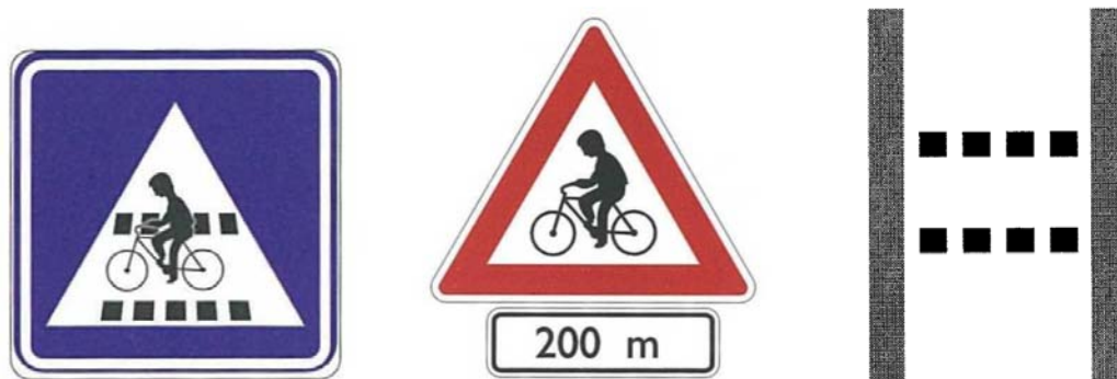
Obr. 7 Dopravní značka č. IP 7 „Přejezd pro cyklisty“, značka č. A 19 „Cyklisté“ s dodatkovou tabulkou č. E 3a „Vzdálenost“ a značka č. V 8 „Přejezd pro cyklisty“
