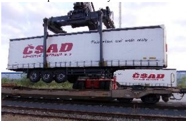
Obr. 8 Manipulace s vlakovým návěsem
