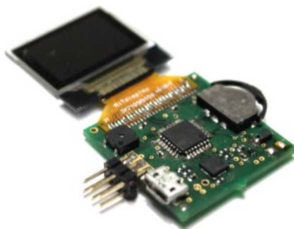
Obrázek 24 - Vyrobená a osazená DPS
