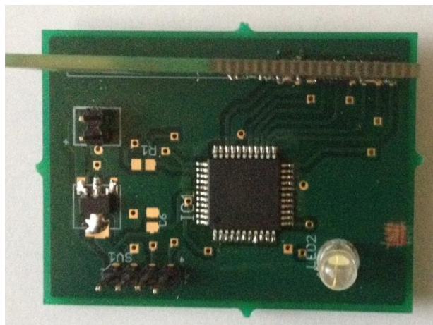
Obrázek 36 Fotografie DPS dálkového ovládání
