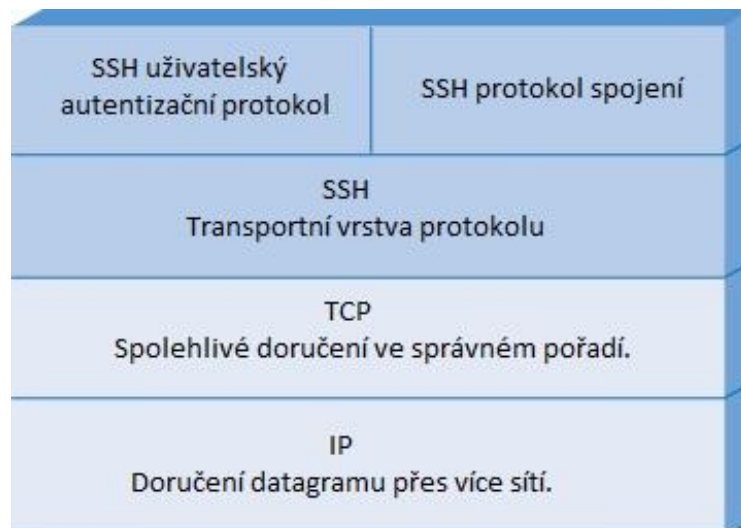
Obrázek 6 – SSH Protokol Stack
