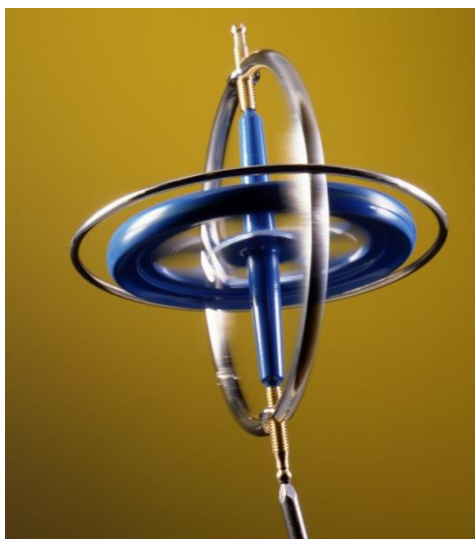
Obr. 1.27 – Mechanický gyroskop (GYROSKOP, 2008)
