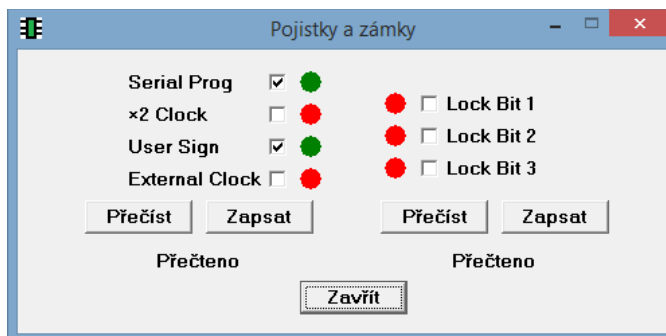
Obrázek 53 Programátor 8051 – nastavení pojistek a zámků
