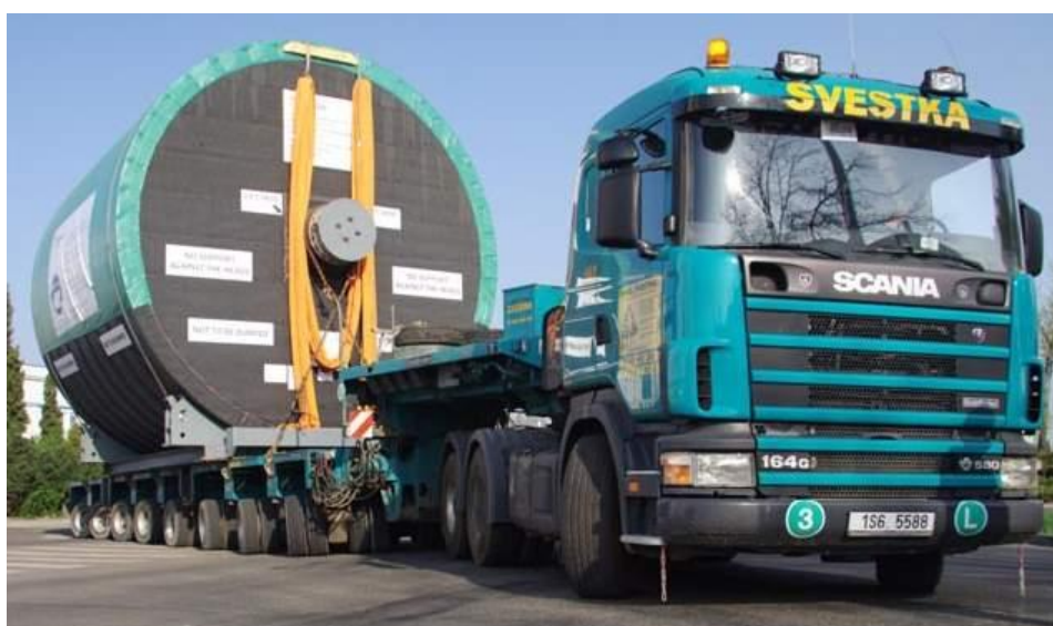
Obrázek 11 Natočení náprav dle potřeby Zdroj: (12)
