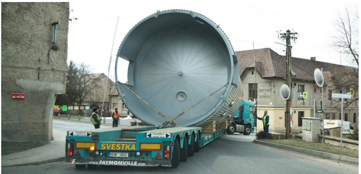
Obrázek 9 Natáčení náprav podle tažného vozidla
