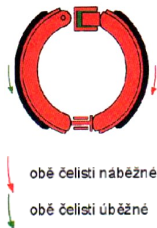
Obrázek 4 Bubnová brzda se spřaženými čelistmi [2]
