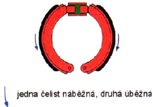
Obrázek 2 Bubnová brzda jednonáběžná [2]
