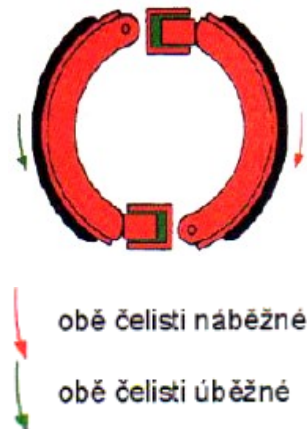
Obrázek 3 Bubnová brzda dvounáběžná [2]
