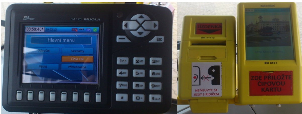
Obrázek 5 Centrální počítač vozidla, termotiskárna a čtečka čipových karet s displejem
