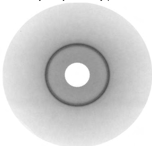
Obr. 2: Difraktogram na práškovém vzorku
