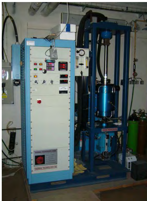
Obr. 2: Lis pro vysoké teploty a vysokotlaké lisování práškových materiálů
