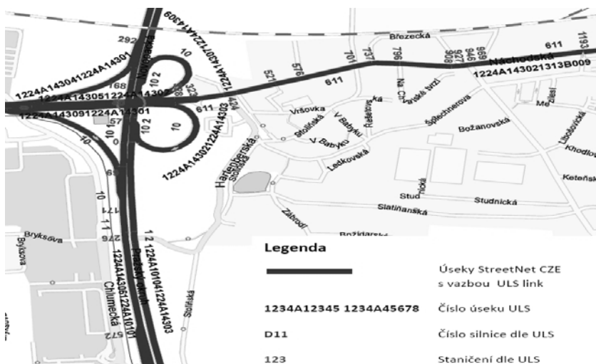
Obr. 1 Rozdíl mezi georeferenčními sítěmi ULS a GN v místě mimoúrovňové křižovatky
