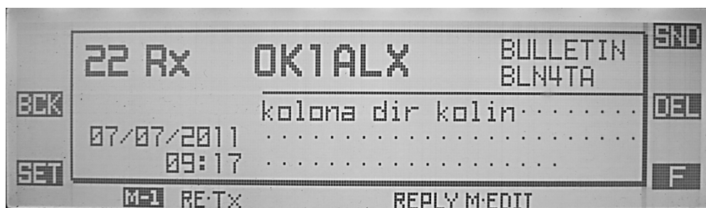
Obr. 1 Možnost vzájemné komunikace mezi objekty na display radiostanice Yaesu FTM-350
