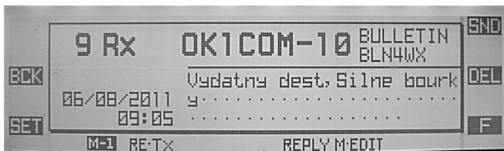
Obr. 3 Upozornění na mimořádné meteorologické jevy na display radiostanice Yaesu FTM-350
