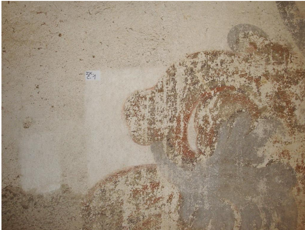
Obr. 10: Zkouška čištění č. 1 v místě levé horní části erbu – po mechanickém odstranění prachových depozitů.
