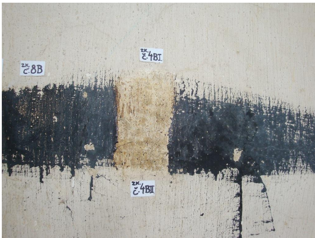
Obr. 24: Zk. č. 4BI – Carbopol EZ2 + dimethylformamid + toluen 1:3, chemické odstranění s kombinací mechanického dočištění dehtového nátěru.
