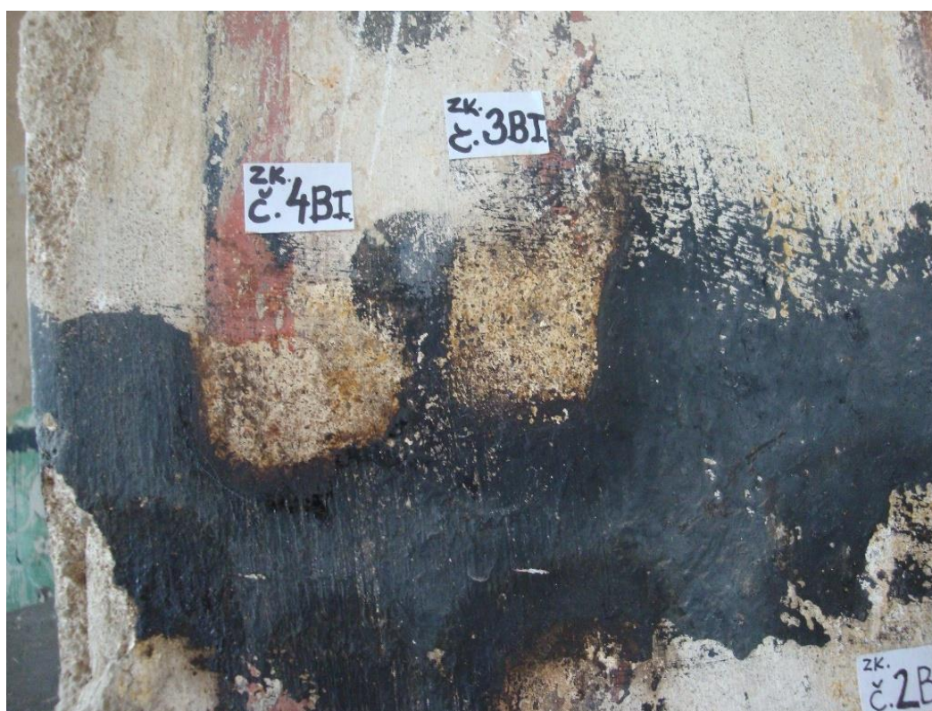
Obr. 26, 27: Zk. č. 3BI (Carbopol EZ2 + diacetonalkohol) a zk. č. 4BI (Carbopol EZ2 + dimethylformamid + toluen 1:3) chemického čištění.
