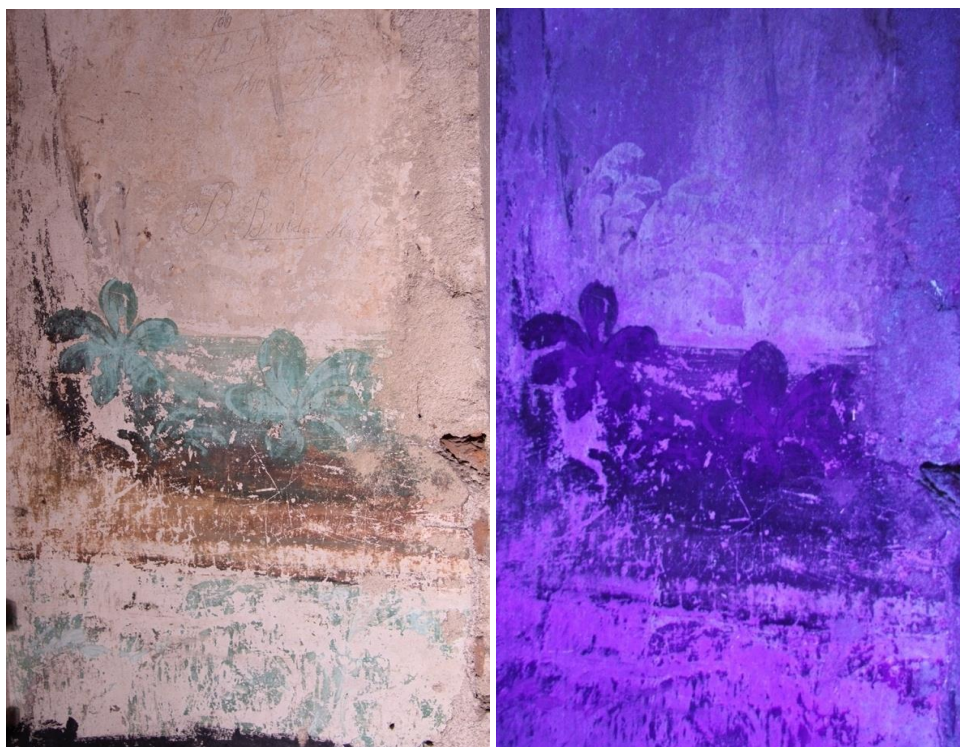
Obr. 32, 33: Spodní část stromu na severní stěně v denním světle poukazuje na graffiti vytvořené nad vegetací a průzkum v odraženém UV světle prokazuje část malby se zaniklými zelenými listy.
