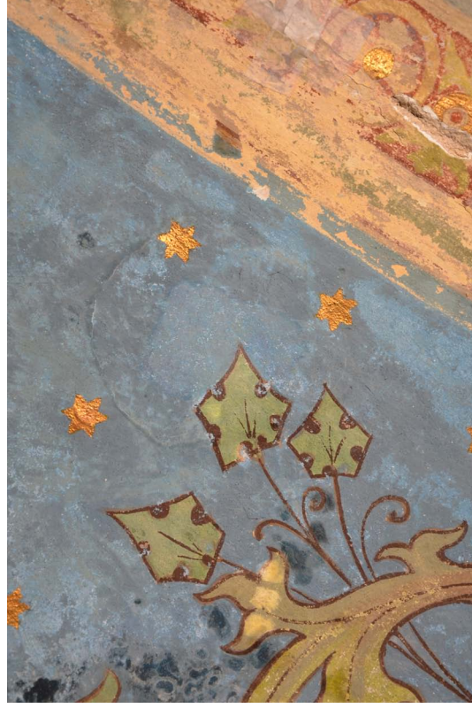
69. Stav po vyschnutí a odstranění zábalu. V okolí zábalu se vytvořila mapa vlivem migrace soli. Zábal byl odstraněn šetrněji postupným odebráním vrstvy Arbocelu skalpelem. V místě zkoušky došlo k úbytku barevné vrstvy.
