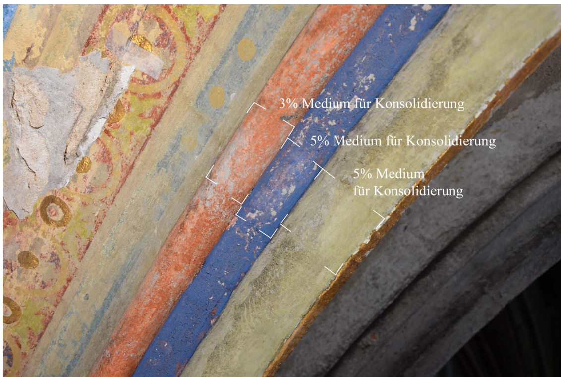
58. Zkoušky prekonsolidace barevných profilů žeber. Zkoušky prekonsolidace byly provedeny 3 - 5 % vodným roztokem Media für Konsolidierung, přípravek byl aplikován nátěrem přes japonský papír. Foto v rozptýleném světle.
