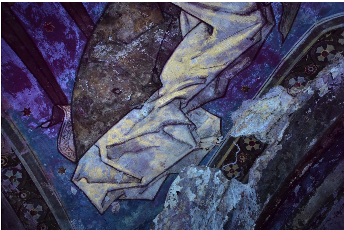
41. Průzkum v UV světle. Detail draperie. Světle žlutě luminuje vrstva přemalby v bílém šatu, přemalba sleduje tvar šatu. Přemalba v pozadí se jeví fialově, na místě poškozeném zatékáním modře. Stav před restaurováním.
