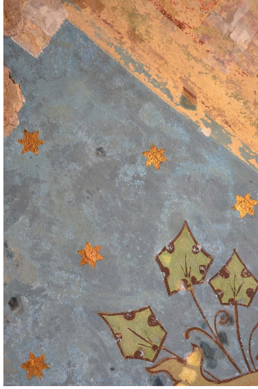
67. Zkouška odsolování pomocí odsolovacího zábalu z Arbocelu a destilované vody (ZII). Stav před nanesením zábalu.
