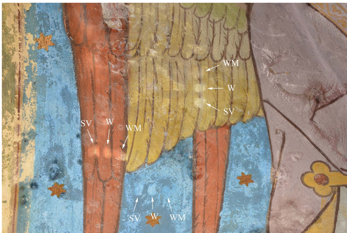
47. Zkoušky snímání přemalby: SV - pomocí skelného vlákna, W - pomocí houby Wishab, WM - pomocí houby Wall Master. Přemalba je na těchto místech snadno odstranitelná všemi zkoušenými způsoby, ale dochází k narušení a úbytkům i spodní barevné vrstvy. Nejšetrnější je způsob mechanického snímání pomocí houby Wall Master.
