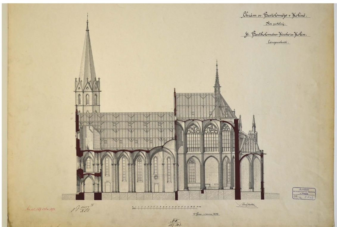
10. Plán na obnovu kostela od Josefa Mockera z roku 1898. Podélný průřez. Národní archiv, fond Sbirka map a plánů. Inv. č. 2759, sign. E/XIX/2/1-20.
