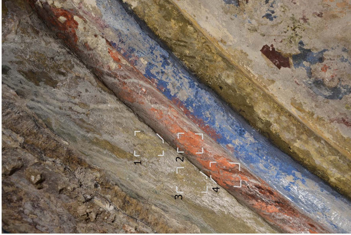
59 Zkoušky čištění vápenného povlaku: 1, 2 - mokré čištění kyselinou citronovou 5% ve vodě 3, 4 - mechanické čištění štětcem ze skelného vlákna
