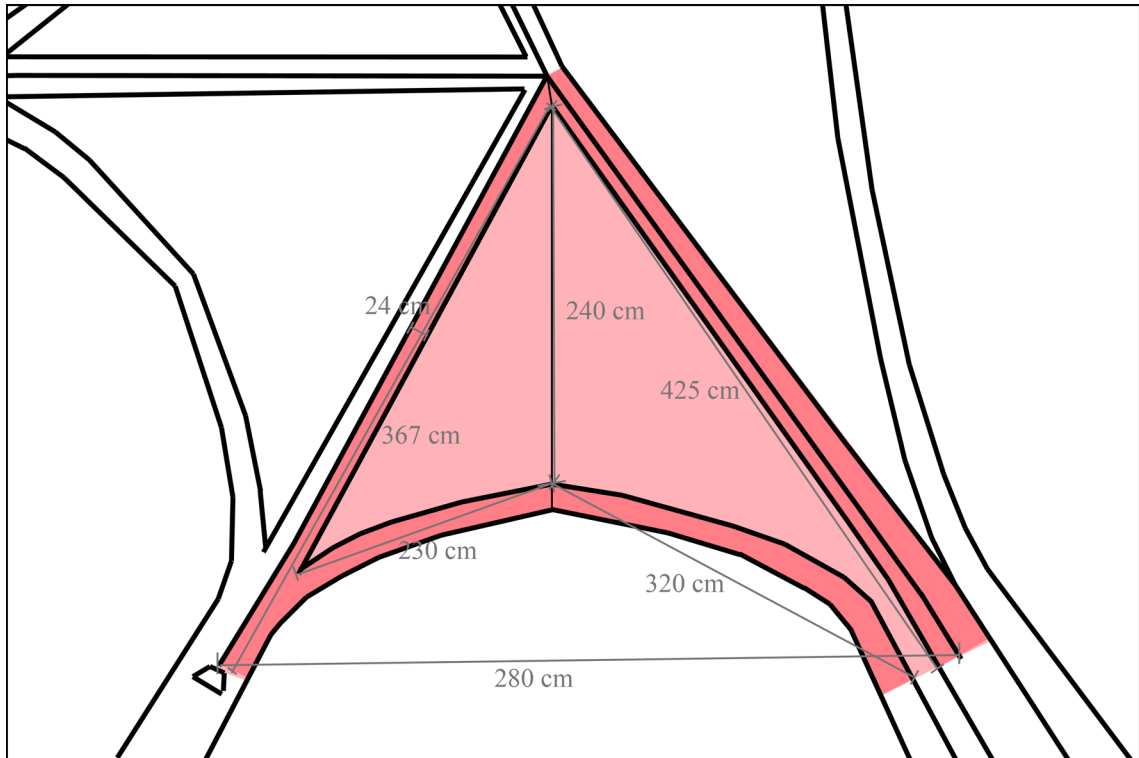
3. Vyznačení rozměrů úseku vymezeného k samostatnému restaurování.
