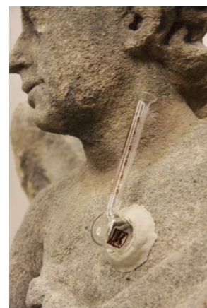
Obr. č. 8 - Ilustr. Měření nasákavosti Karstenovou trubicí
