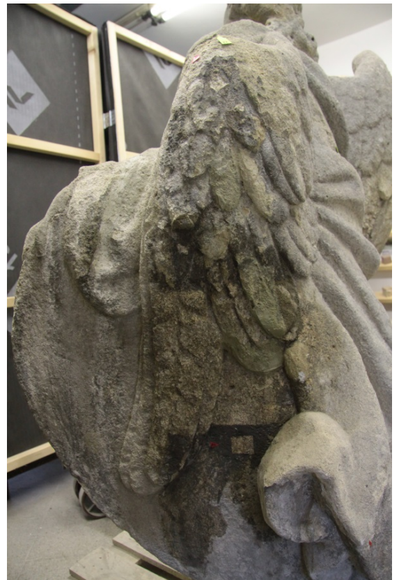
Obr. č. 19 – Průběh čištění laserem
