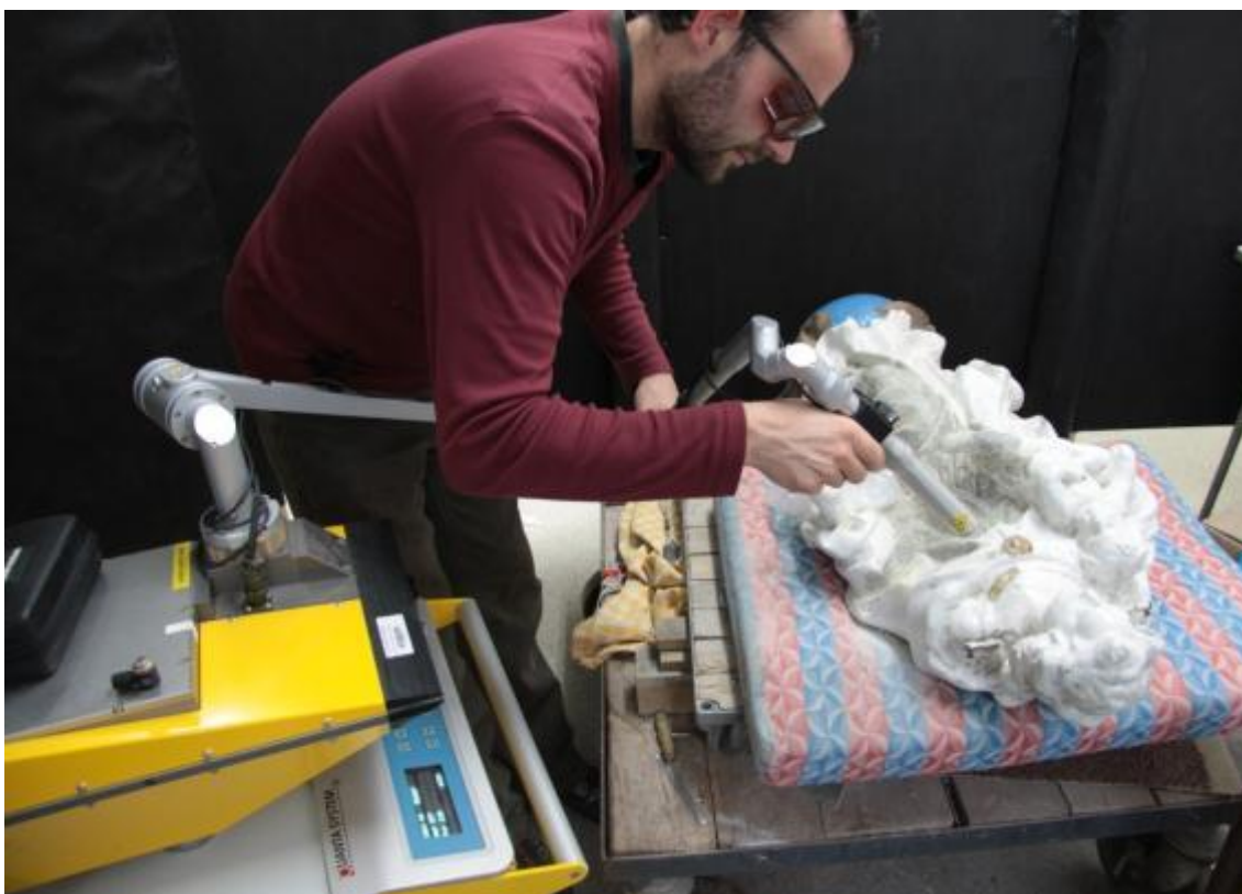
Obr. 103 Laserové čištění bílého nátěru od zlatěnky
