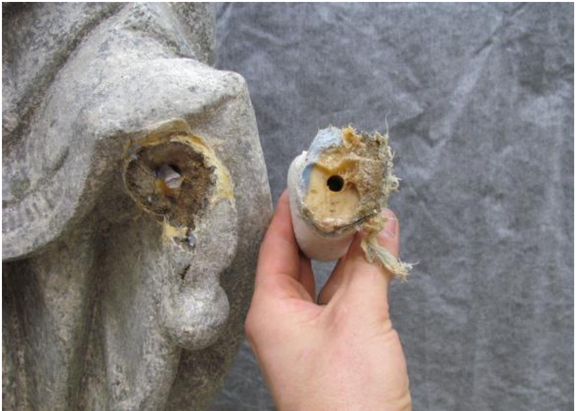
Obr. 106 Doplněk levé ruky Marie po oddělení, lepený na epoxidovou pryskyřici, zajištěný kovovým čepem
