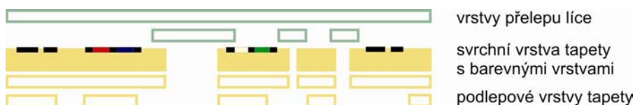
Obr. 43 Schéma vrstev tapety po dokončení druhé fáze restaurování
