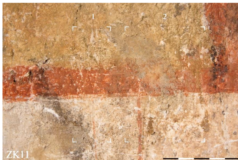
Obr. 106. ZK11 – zkouška čištění a ztenčení retuší a přemaleb, rozhraní šatu levé polofigury a stolu. Částečné čištění nezpůsobuje pozorovatelné úbytky barevné vrstvy.
