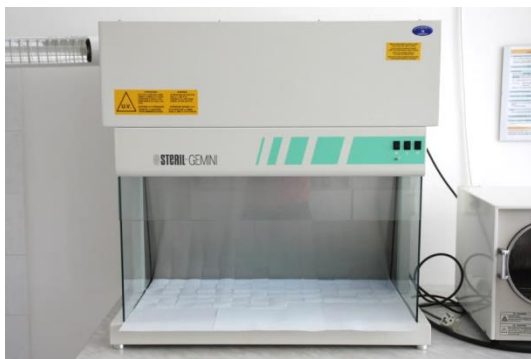
Obr. 169. Sterilizace zkušebních tělísek. Laminární box s UV lampou (253,7 nm, 15 W).
