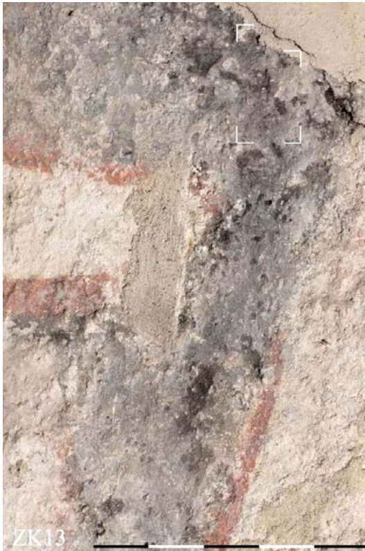
Obr. 110. ZK13 – zkouška čištění a ztenčení nepůvodního vápenného zákalu, pozadí mezi donátorem a sv. Dorotou. lazurnější vrstvy a vápenný zákal nebylo možné odstranit ani ztenčit bez částečného úbytku barevné vrstvy.
