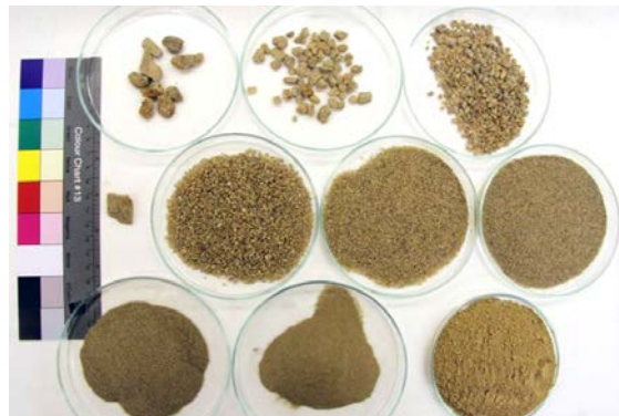
Obr. 113. Vz. V25a – frakce zrn kameniva vzorku. Zleva nahoře: 16, 8, 4, 2, 1, 0,5, 0,25, 0,125, 0,063 mm). Obr. převzat viz. Lesniaková, 2012 105 a upraven.
