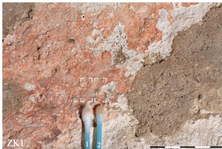
Obr. 95. ZK1 – zkouška citlivosti barevné vrstvy na mechanické namáhání, draperie stolu.
