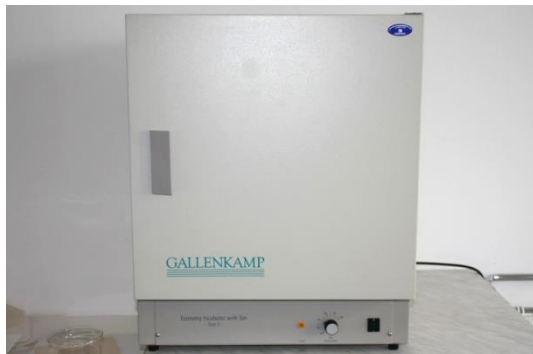
Obr. 173. Biologický inkubátor, ve kterém byly uloženy zkušební vzorky.
