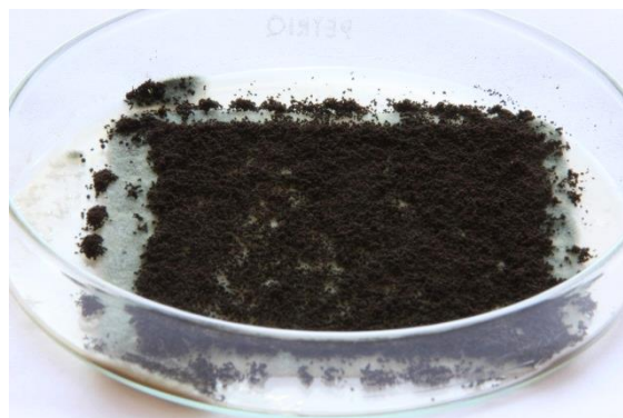
Obr. 192. Vz. 50, podložka , plísň dle ČSN EN 15457. Vzorky z podložky, stejně jako z Klucel em G, byly nejvíce propustné pro živiny z půdy a nejméně mechanicky omezovaly růst plísní.
