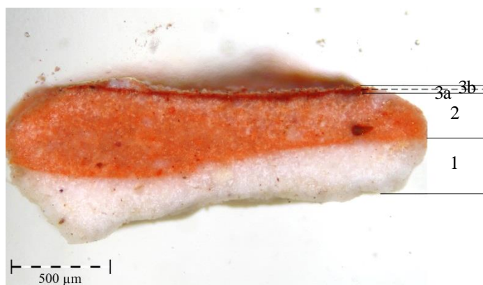
Obr. 121. Vz. V8, souvrství středověké nástěnné malby, arkáda – mikrofoto nábrusu vzorku v bílém odraženém světle při zvětšení 50 ×. Demonstrace provedení barevných vrstev.
