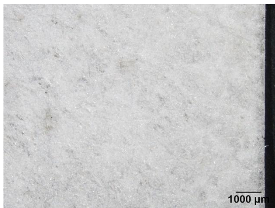
Obr. 231. Vz. 33, Klucel G , plísňě dle nálezu v Pošné, mikrofoto. Na povrchu vzorků není patrný nárůst plísni. Povrch je srovnatelný s povrchem nekontaminovaných nekultivovaných vzorků [srov. Obr. 237., 239., 241.].
