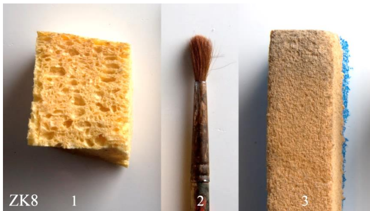
Obr. 101. ZK8 – pozorování míry úbytku barevné vrstvy při čištění. U vlasového štětce (2) byl pozorován sprášený materiál během čištění. U hub Wishab (3) a Viskovita (1) byla sledována spráškovatělá barevná vrstva, ulpělá na jejich povrchu.
