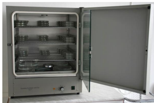
Obr. 174. Uložení Petriho misek se zkušebními vzorky v biologickém inkubátoru. Na dně inkubátoru jsou Petriho misky s vodou a vlhkoměr pro udržování požadované vlhkosti.
