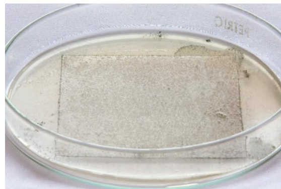
Obr. 208. Vz. 59, Primal WS 24 , plísně dle nálezu v Pošné. Na površích vzorků s filmem Klucelu G a Primalu WS 24 byl pozorován podobný růst plísní, silnější než na vzorcích z podložky.
