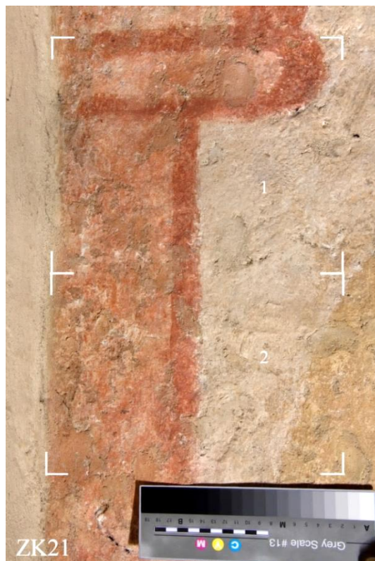
Obr. 119. ZK21 – rozšířená zkouška povrchové konsolidace a aplikace vybraného konsolidantu, arkáda a pozadí za levou polofigurou.
