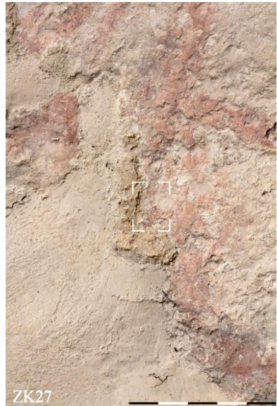
Obr. 126. ZK27 – zkouška hloubkové konsolidace vápenných nátěrů s barevnou vrstvou, šatu sv. Doroty.
