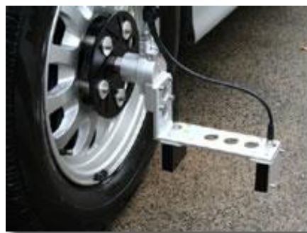
Obrázek 3 – Princip optického snímače rychlosti [2][3]
