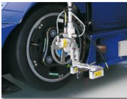
Obrázek 2 - Přípravek na měření dynamiky a otáček vozidla [3]
