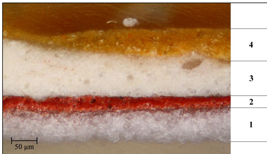
Obr. č. 23: Bílé dopadající světlo, fotografováno při zvětšení mikroskopu 200x.
