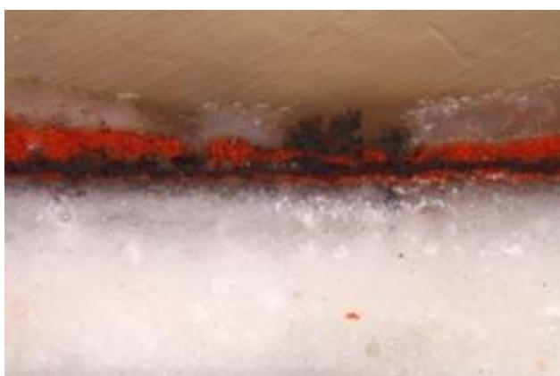
Obr. č. 71: Bílé dopadající světlo, fotografováno při zvětšení mikroskopu 200x – detail koroze.
