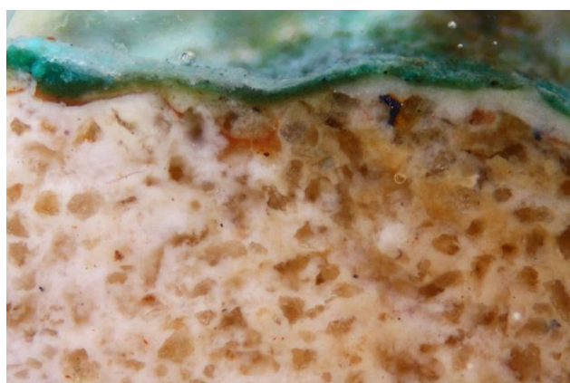
Obr. č. 78: Bílé dopadající světlo, fotografováno při zvětšení mikroskopu 50x – vzorek s podkladovým štukem.
