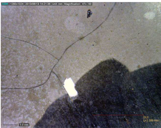
Krakely a ztráty v kolódiové vrstvě.
