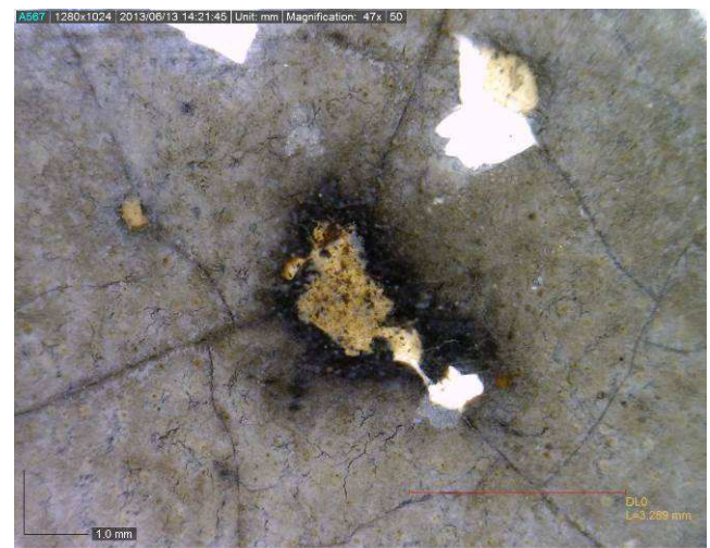
Tvorba tmavých skvrn neznámého původu v emulzní vrstvě.
