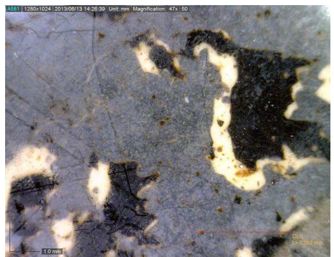
Defekty způsobené odtržením papírového štítku spolu s obrazovou vrstvou.
