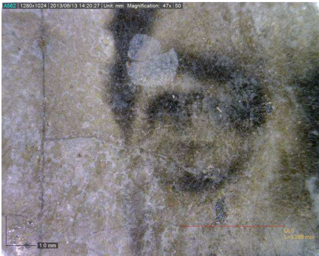
Mezi kolódiovou vrstvou a skleněnou deskou se tvoří vzduchové bubliny.
