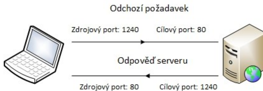
Obrázek 4 – Princip zdrojových a cílových portů
