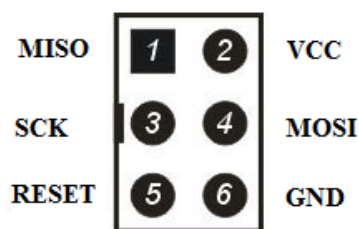
Obrázek 30 - Zapojení ISP konektoru (6. vodičové)
