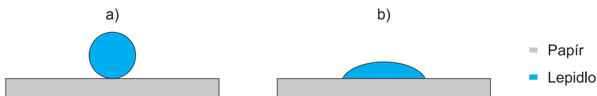
Obr. 5. Smáčení povrchu lepidlem, a) lepidlo povrch nesmáčí, b) lepidlo povrch smáčí.
