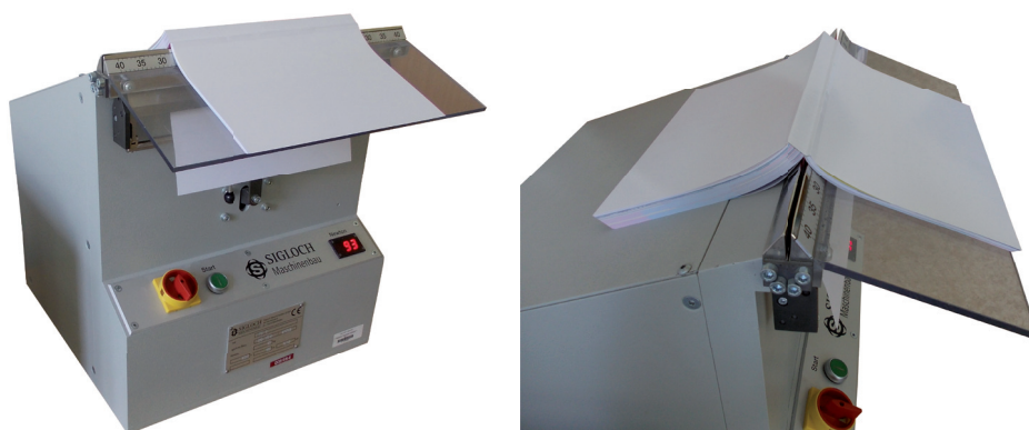
Obr. 9. Testovací zařízení Pull-tester Sigloch PT-1.
