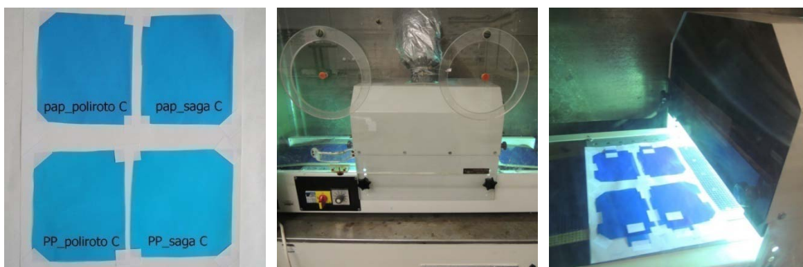
Obrázek č. 7 – vzorky nátisků, UV tunel, nátisky procházející tunelem
