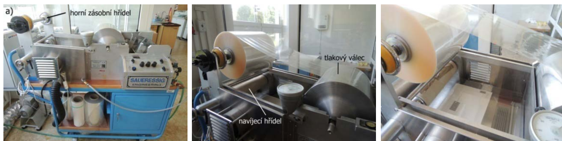
Obrázek č. 4 – nátiskový stroj, natažení a napnutí potiskovaného materiálu - a)
