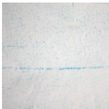
Obrázek č. 16 – Stopy po oděru papíru potištěného biodegradabilní barvou, po osvitu UV
