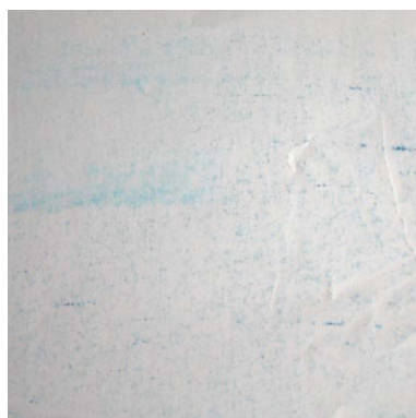
Obrázek č. 18 – Stopy po oděru papíru potištěného klasickou flexotiskovou barvou, po osvitu UV
