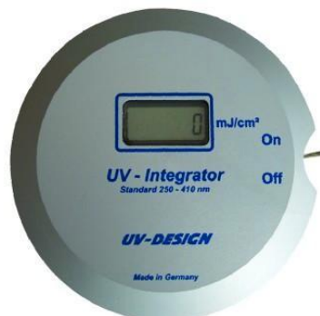
Obr. 4. Radiometr UV Integrátor (UV-technik) [30]
