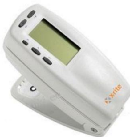
Obr. 6. Spektrofotometr X - Rite 530x [34]
