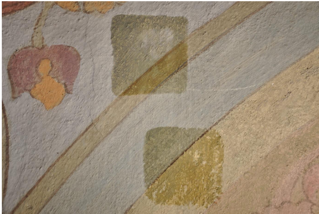
Obr. 51 Zkouška prekonsolidace vhodnou koncentrací Klucelu E: nahoře 2%, dole 3% roztok Klucelu E.
