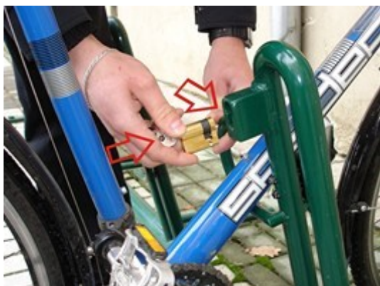
Obrázek č. 15: Princip bezpečnostních stojanů pro cyklisty
