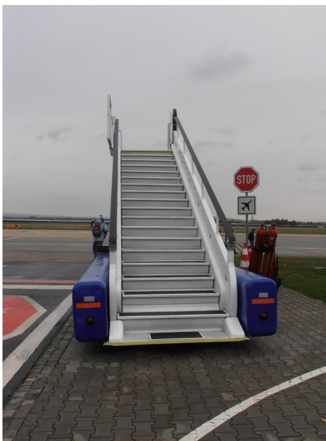
Obrázek 5 Schůdky používané pro nástup a výstup cestujících
