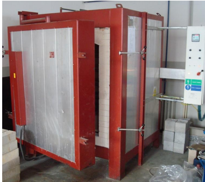
Obr. 11 – Elektrická pec BVD-800/K
