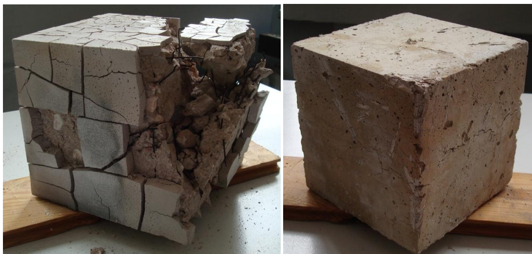
Obr. 13 – Drátobetón (vlevo) BVPV (vpravo) po extrémním teplotním namáhání
