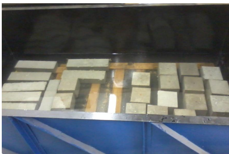
Obr. 9 – Vyrobená tělesa uložena ve vodní nádrži
