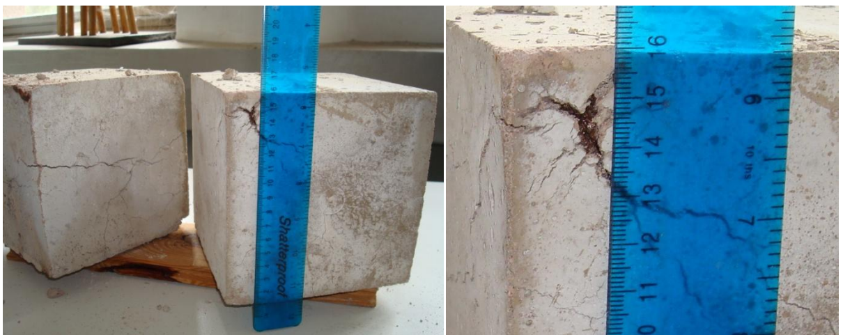
Obr. 12 – Tělesa z prostého betonu po extrémním teplotním namáhání
