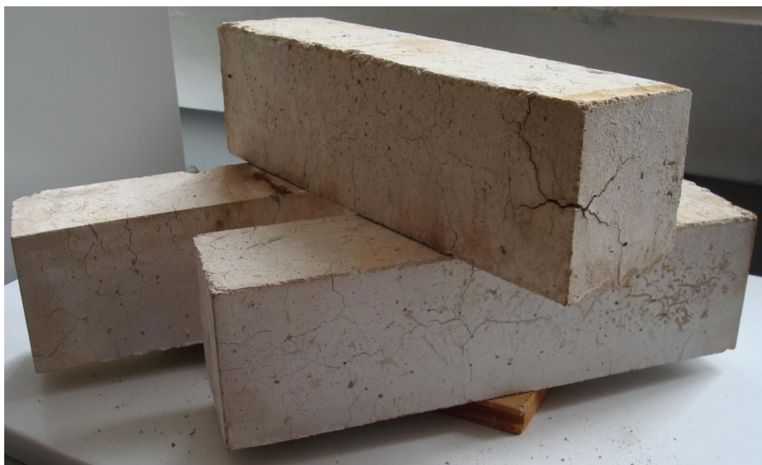
Obr. 14 – Zkušební tělesa z prostého betonu nevykazovala žádnou pevnost v tahu za ohybu
