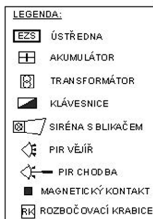
Obrázek 21: Schématické značky prvků tvořících systém EZS
