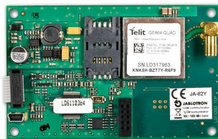
Obrázek 4: GSM komunikátor Jablotron JA-82Y [4]
