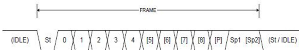
Obrázek 24: Diagram přenosu rámce po UART sběrnici [11]
