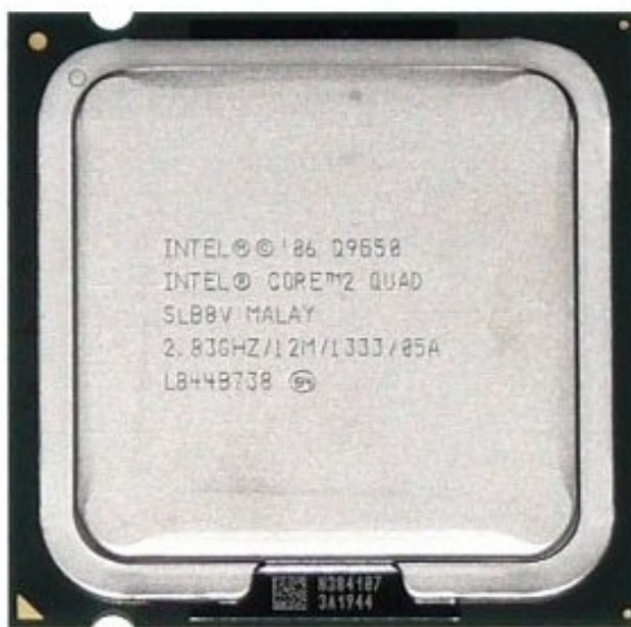
Obrázek 6 - Procesor Intel Core 2 Quad Q9650
